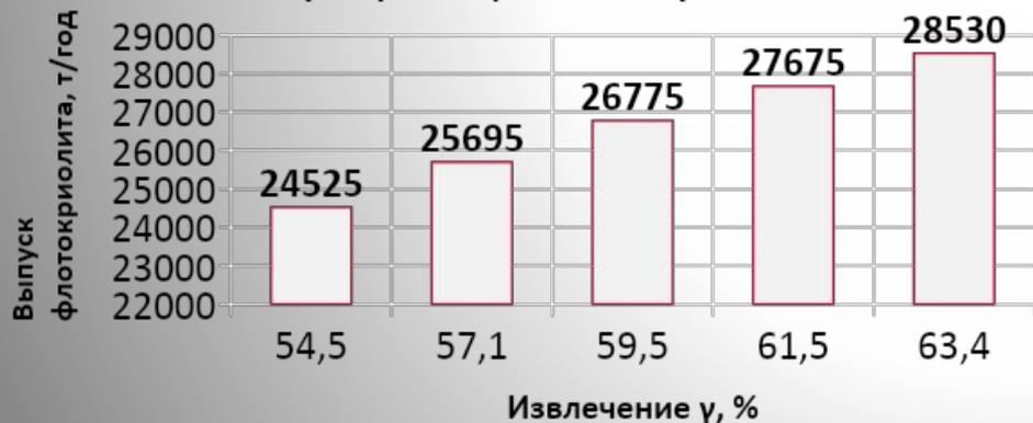
Результаты флотации угольной пены, шлама и пыли газоочистки с предварительной отмывкой горячей водой и измельчением в шаровой мельнице
