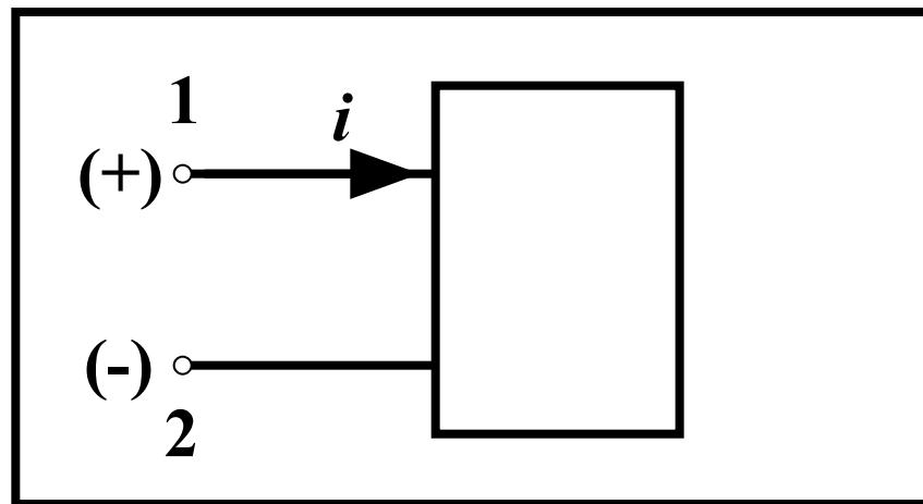
**Для измерения тока применяются амперметры. Амперметр включается последовательно в цепь и измеряет ток на данном участке цепи.**
