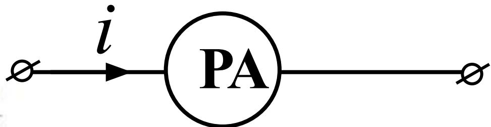
**Внутреннее сопротивление идеального амперметра равно нулю.**
