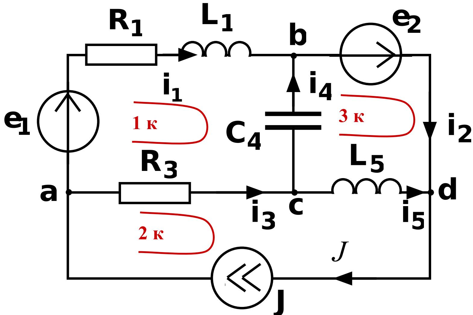
**Граф – это изображение схемы в виде линий (ветвей) и точек (узлов). Стрелки на графике показывают направления токов в ветвях.**
