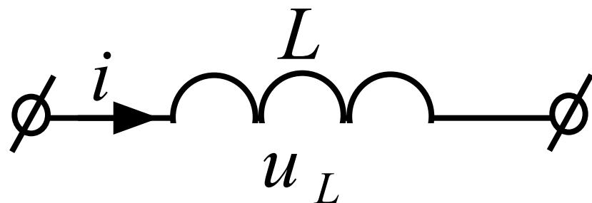
**Индуктивность  $L$  – это коэффициент пропорциональности между потокосцеплением и током, текущим через катушку:**
