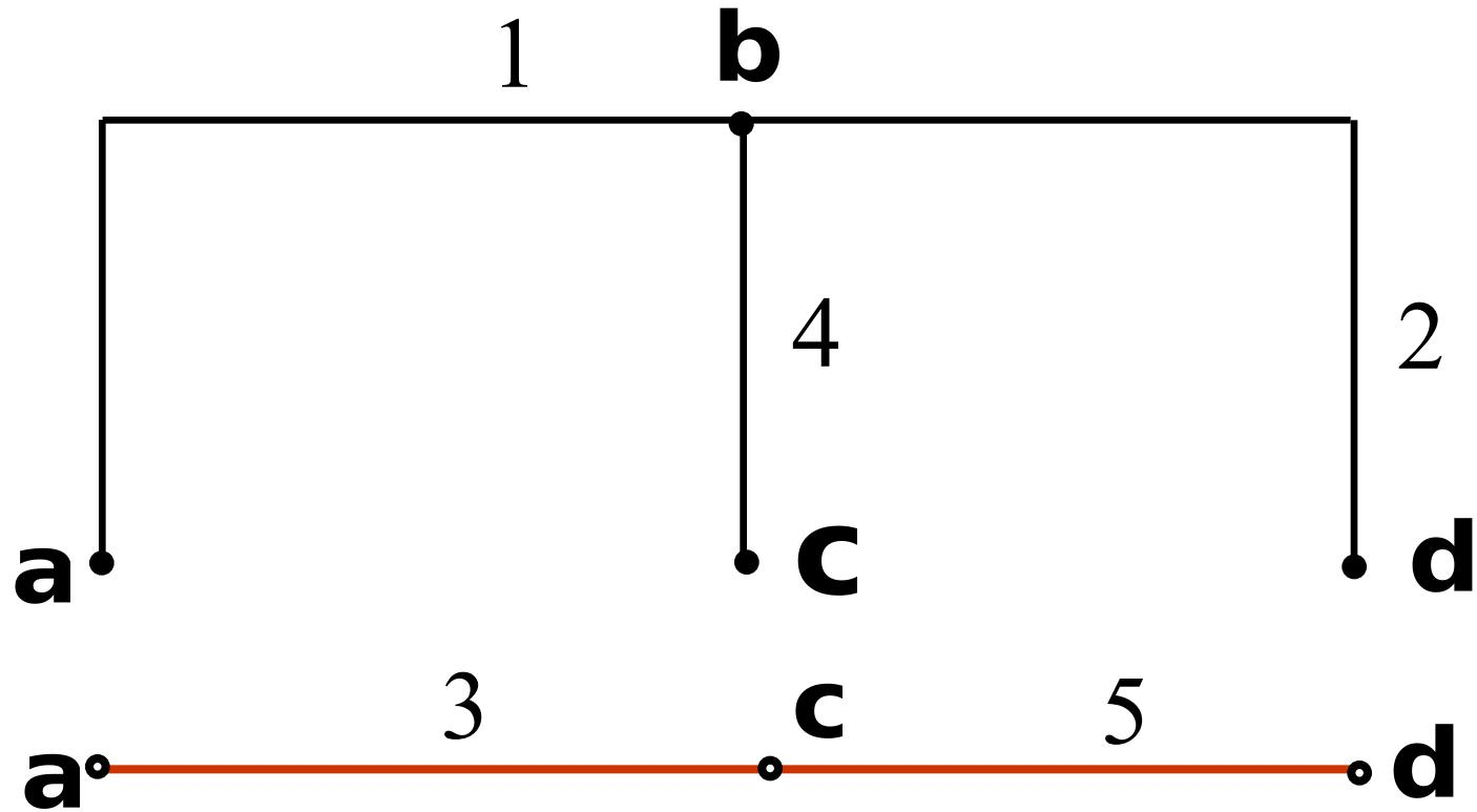
**Независимый контур – это контур, который состоит из ветвей дерева и только одной хорды. Число независимых контуров равно числу хорд**
