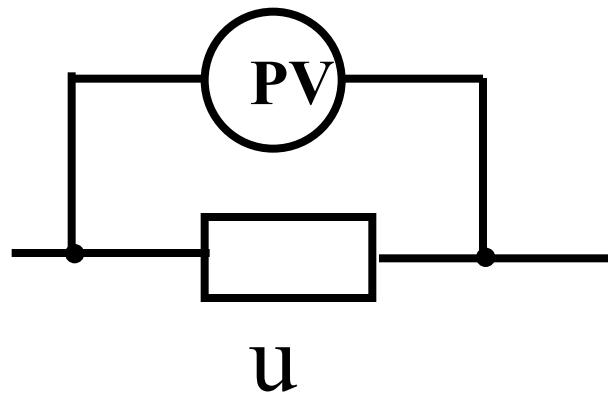
**Внутреннее сопротивление идеального вольтметра равно бесконечности**
