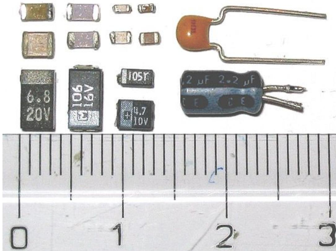
**Слева - конденсаторы для поверхностного монтажа;
