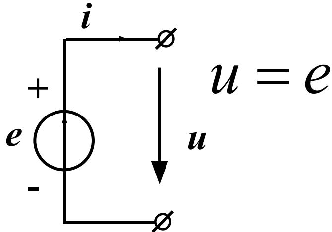
Стрелка указывает точку более высокого потенциала. Источник вырабатывает энергию, поэтому ток внутри него течет от точки более низкого к точке более высокого потенциала.
