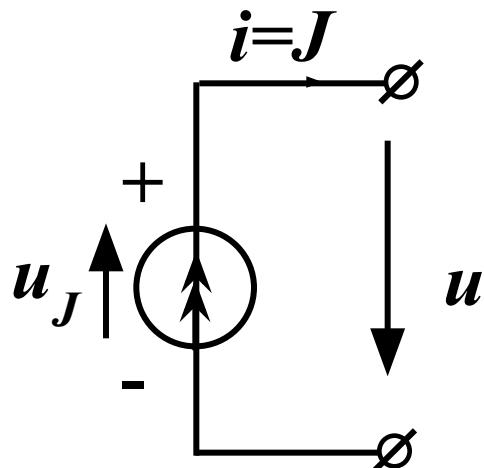
**Полярность напряжения  $u_J$  соответствует случаю, когда источник вырабатывает энергию.**
