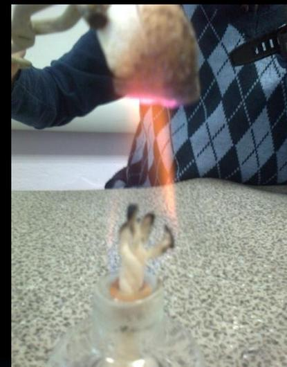
При помощи тигельных щипцов внесли скорлупу в пламя спиртовки. Пламя окрасилось в кирпично-красный цвет.
