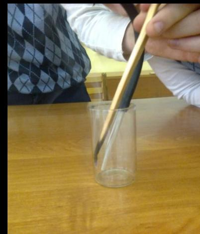
Под действием соляной кислоты скорлупа начинает выделять газ. Образовавшийся газ не поддерживает горение. Вывод: Это углекислый газ. Он выделяется из солей угольной кислоты. Значит в состав скорлупы входит соль угольной кислоты – карбонат кальция.
