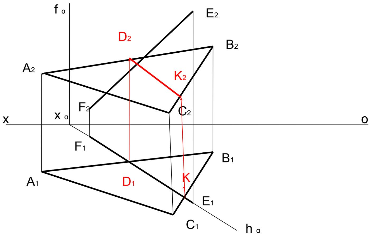
3 Найти  $(\bullet)M(M_2M_1) - (\bullet)$  пересечения линии ДК  $(D_2K_2)(D_1K_1)$  и прямой  $EF(E_2F_2; E_1F_1)$   $(\bullet) M = DK \cap EF$
