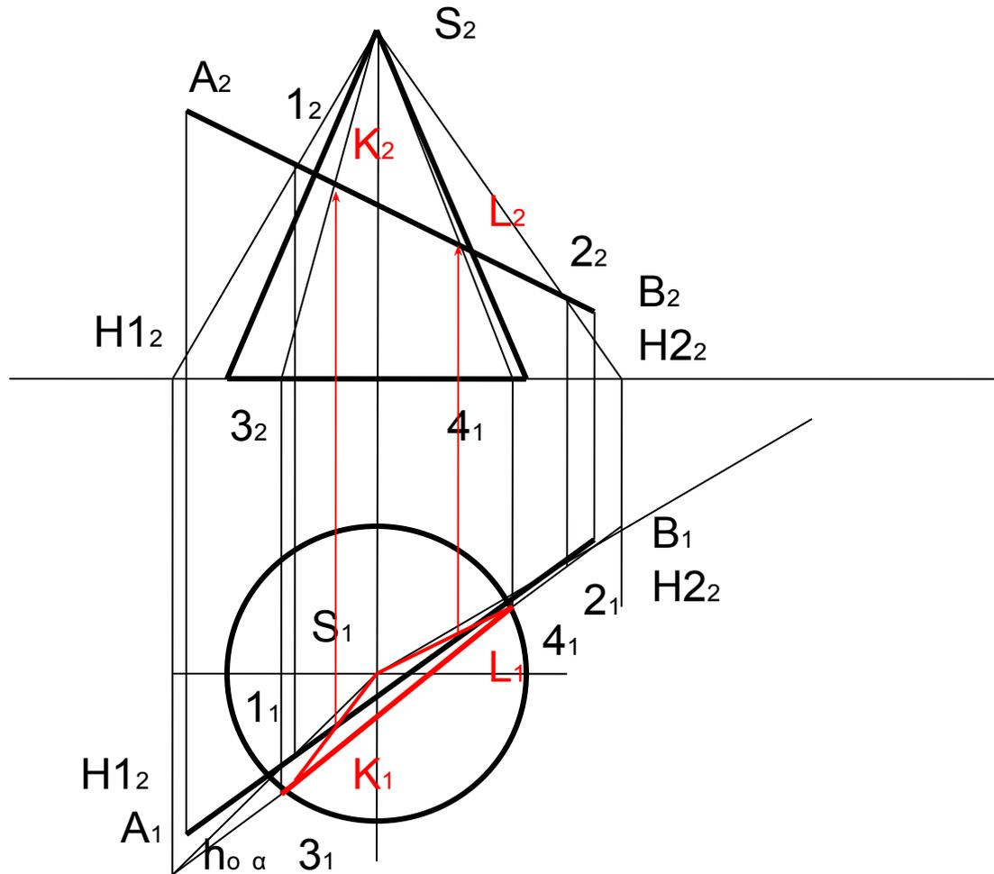
В пересечении образующих  $S3$  и  $S4$  с заданной прямой определяем искомые Точки.  $AB \cap S3 = K$   $AB \cap S4 = L$ . Определяем видимость прямой линии  $AB$ .
