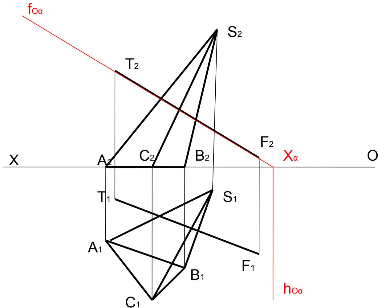
3. Строим линию пересечения вспомогательной плоскости  $\alpha$  ( $f_{0\alpha}$   $h_{0\alpha}$ ) с поверхностью заданного многогранника фронтальная проекция сечения плоскости  $\alpha$  с поверхностью пирамиды ( $1_2 2_2 3_2$ ) совпала с фронтальным следом  $f_{0\alpha}$  плоскости  $\alpha$ . горизонтальная проекция сечения  $1_1 2_1 3_1$  определилась по точкам  $1_1 2_1 3_1$  лежащим на соответствующих ребрах пирамиды ('построение показано стрелками),
