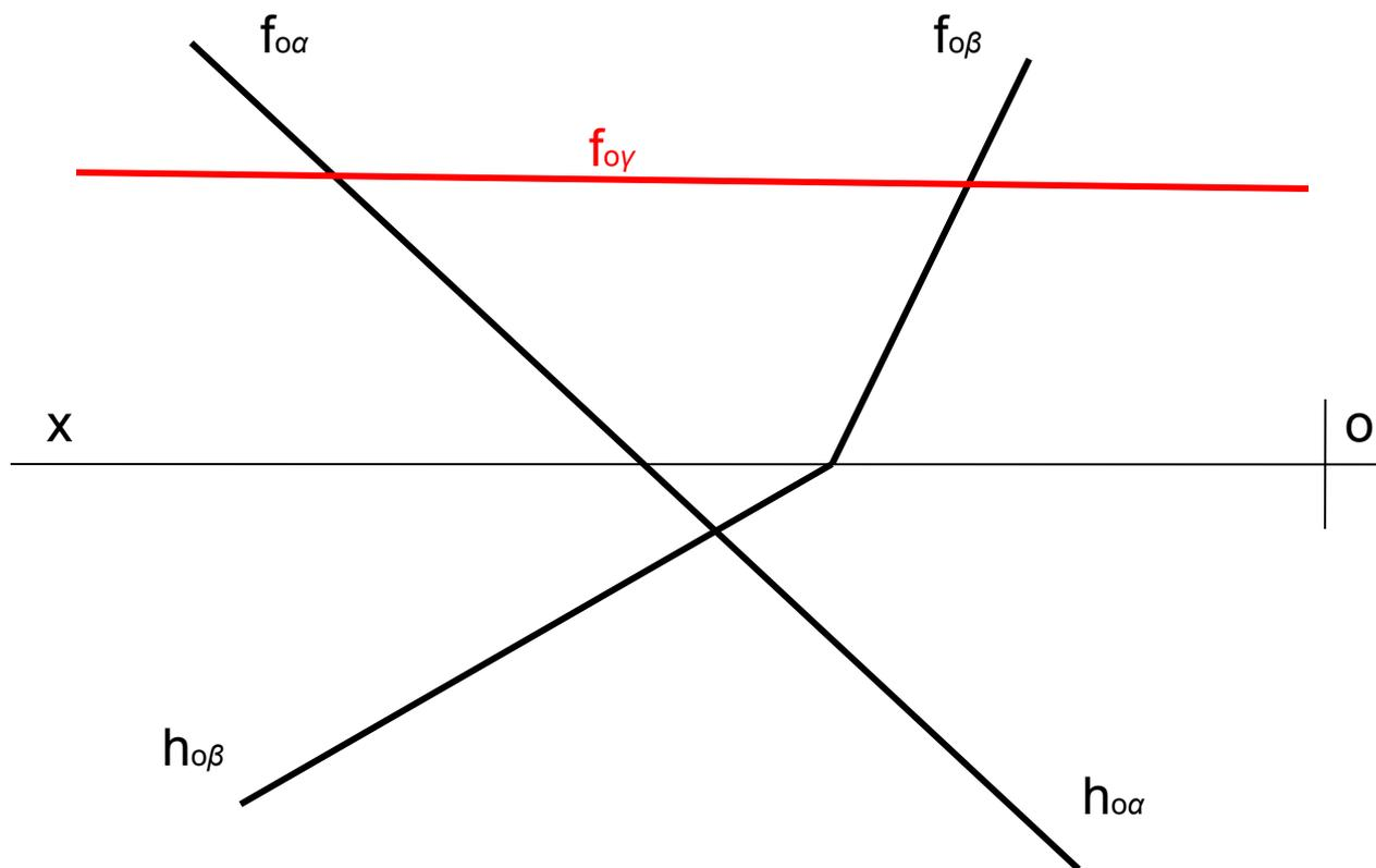
4. Определить точку  $K(K_2, K_1)$  принадлежащую линии пересечения плоскостей  $\alpha$  и  $\beta$   $NM \cap 12 = K$
