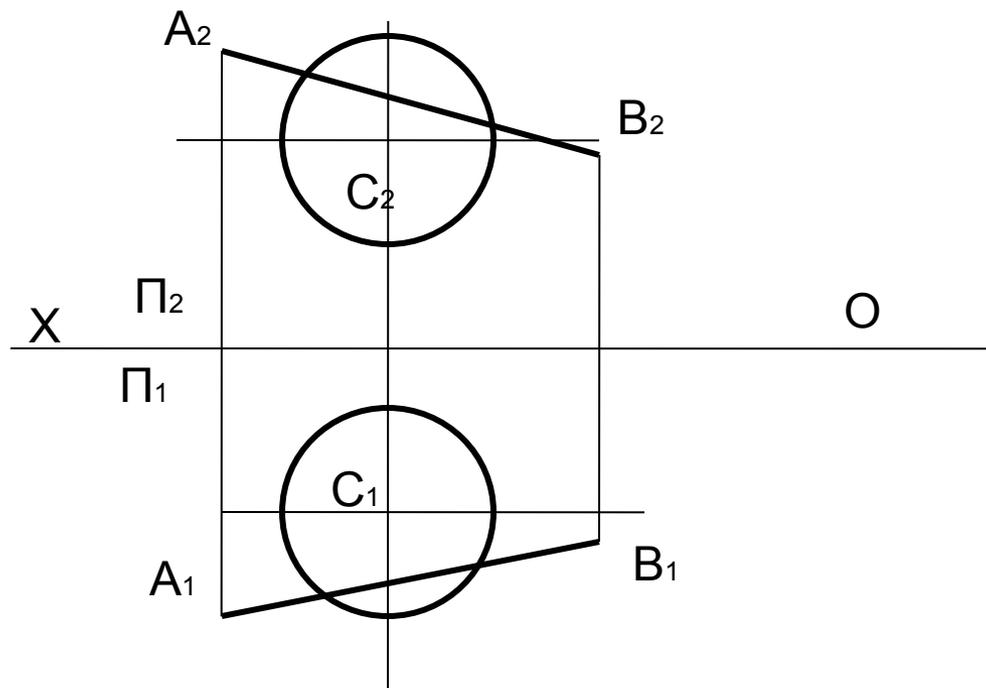
1. Через прямую АВ проводим пл.  $\alpha$   $\Pi_1$  (след  $h_{0\alpha}$  совпадает с горизонтальной проекцией прямой  $A_1B_1$ ). ( $\alpha \perp \Pi_1$ )  $\cap$  ( $A_1B_1 \subset h_{0\alpha}$ ).
