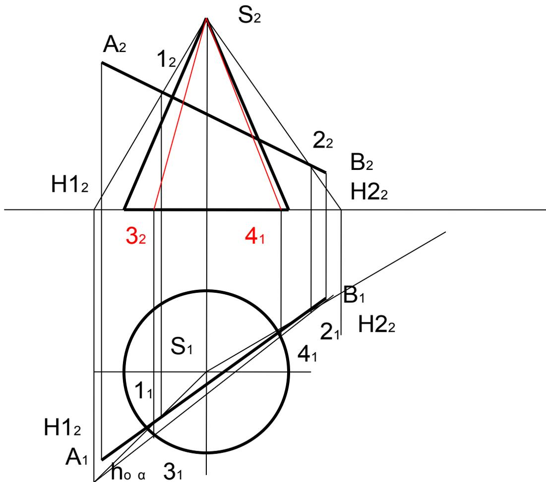
3. Определяем линию пересечения вспомогательной плоскости  $\alpha$  с конусом - это образующие  $S_3$  и  $S_4$ .
