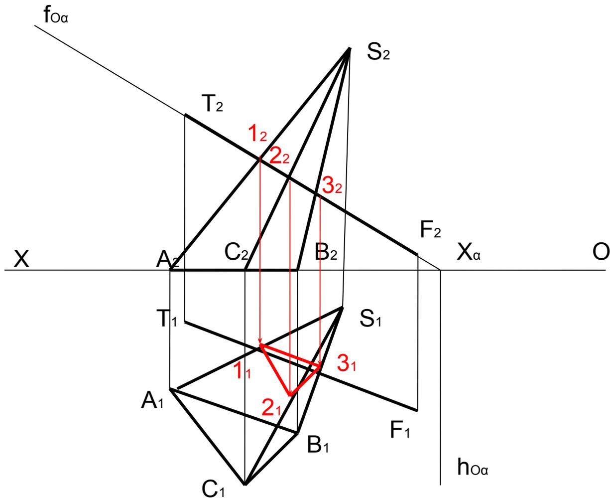
4. Найдем точки пересечения заданной прямой  $TF$  с контуром сечения  $123$  - точки  $K$  ( $K_2 K_1$ ) и  $R$  ( $R_2 R_1$ ). По линиям связи отмечаем точки  $K_2$  и  $R_2$  на фронтальной проекции прямой  $T_2F_2$ . Это и будут искомые точки (входа и выхода) пересечения прямой с поверхностью многогранника (пирамиды).
