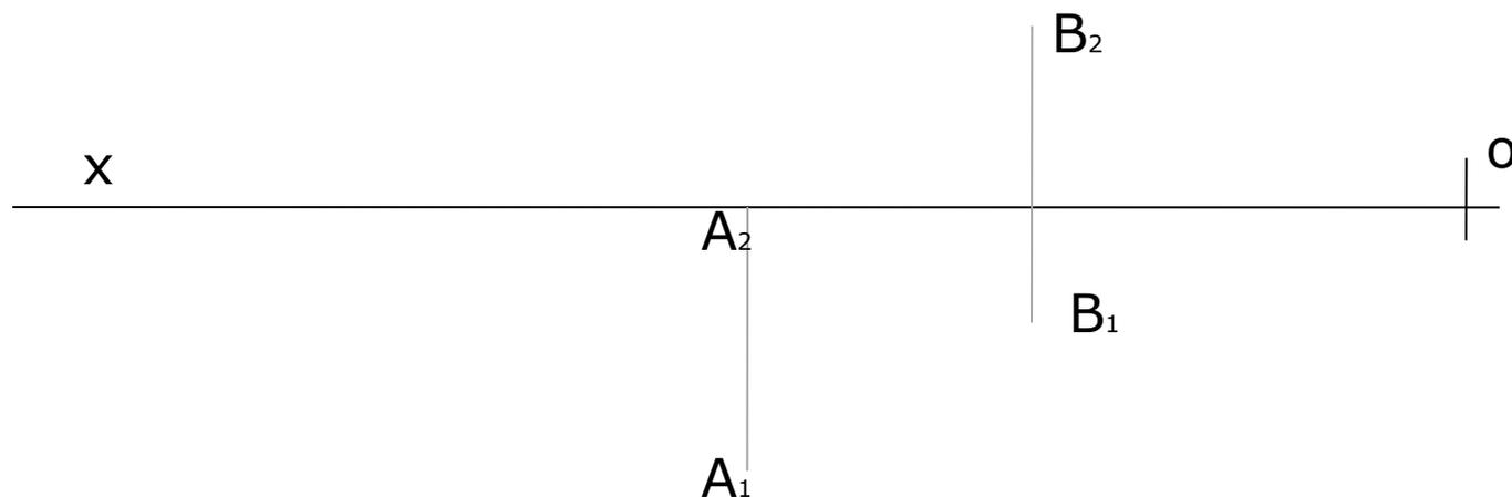
**2. Соединить одноименные проекции точек и определить горизонтальный след прямой - точку  $H$  ( $H_2 H_1$ )**
