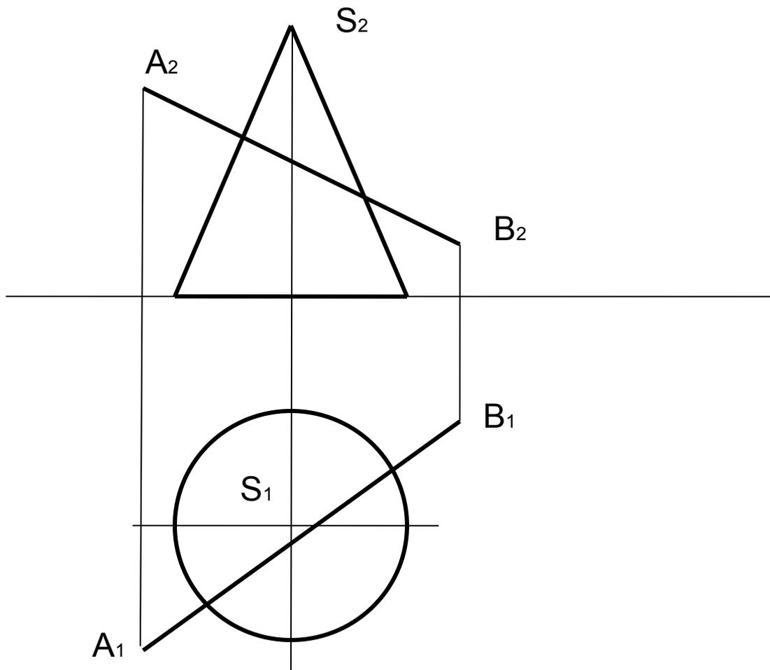
1 Через прямую АВ проводим вспомогательную плоскость. в качестве вспомогательной плоскости принимаем плоскость, проходящую через вершину конуса S, и две точки 1 и 2, произвольно взятые на прямой АВ. Определяем горизонтальные следы  $H_1$ , ( $H_{21}, H_{11}$ ) и  $H_2$  ( $H_{22}, H_{21}$ ) пересекающихся прямых  $S_1$  и  $S_2$ . Точки 1 и 2 следует выбрать с таким расчетом, чтобы горизонтальные следы  $H_1$  и  $H_2$  получились в пределах чертежа.
