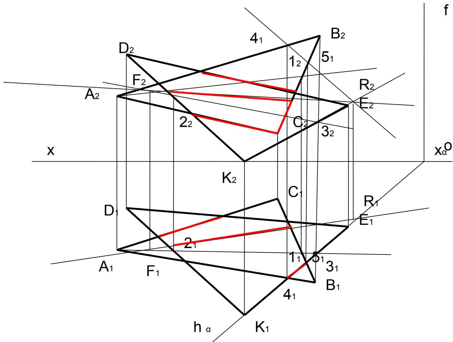
5. Даем характеристику найденной линии пересечения относительно плоскостей проекций.
