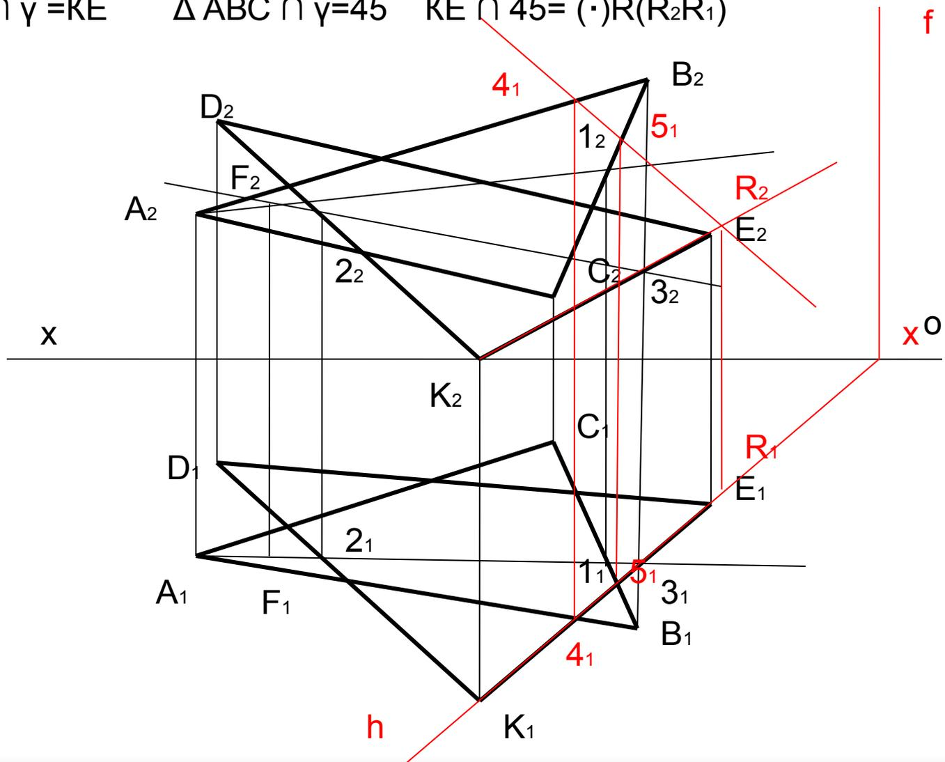
3. Соединив одноименные проекции точек F и R, получим проекции линии пересечения плоскостей  $\Delta ABC \cap \Delta DKE = FR$
