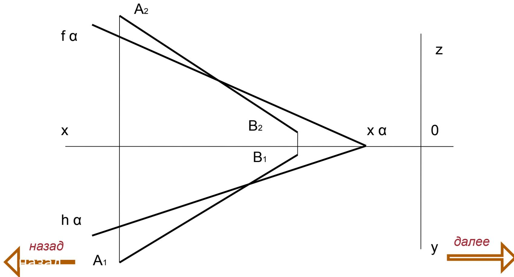
**Задача** Построить следы плоскости  $a$ , заданной тремя точками  $A, B, C$ . В плоскости  $a$  построить горизонталь, отстоящую на расстоянии двух единиц от горизонтальной плоскости  $\pi_1$  и фронталь отстоящую на расстоянии трех единиц от фронтальной плоскости проекций  $\pi_2$ .
