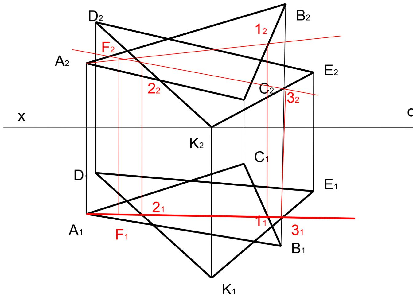
2. Для получения второй точки линии пересечения  $\Delta ABC$  и  $\Delta DKE$  воспользуемся плоскостью  $\gamma \perp \Pi_1$  и проходящей через сторону  $KE$   $\Delta DKE$
