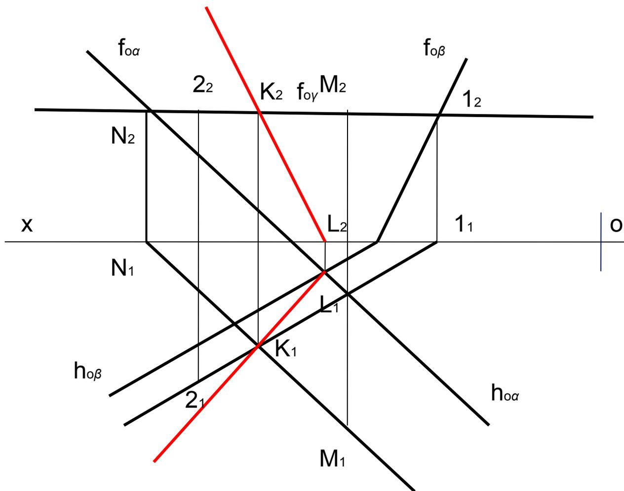
7, Определить характеристику линии пересечения относительно плоскостей проекций ( $\Pi_1\Pi_2$ ).
