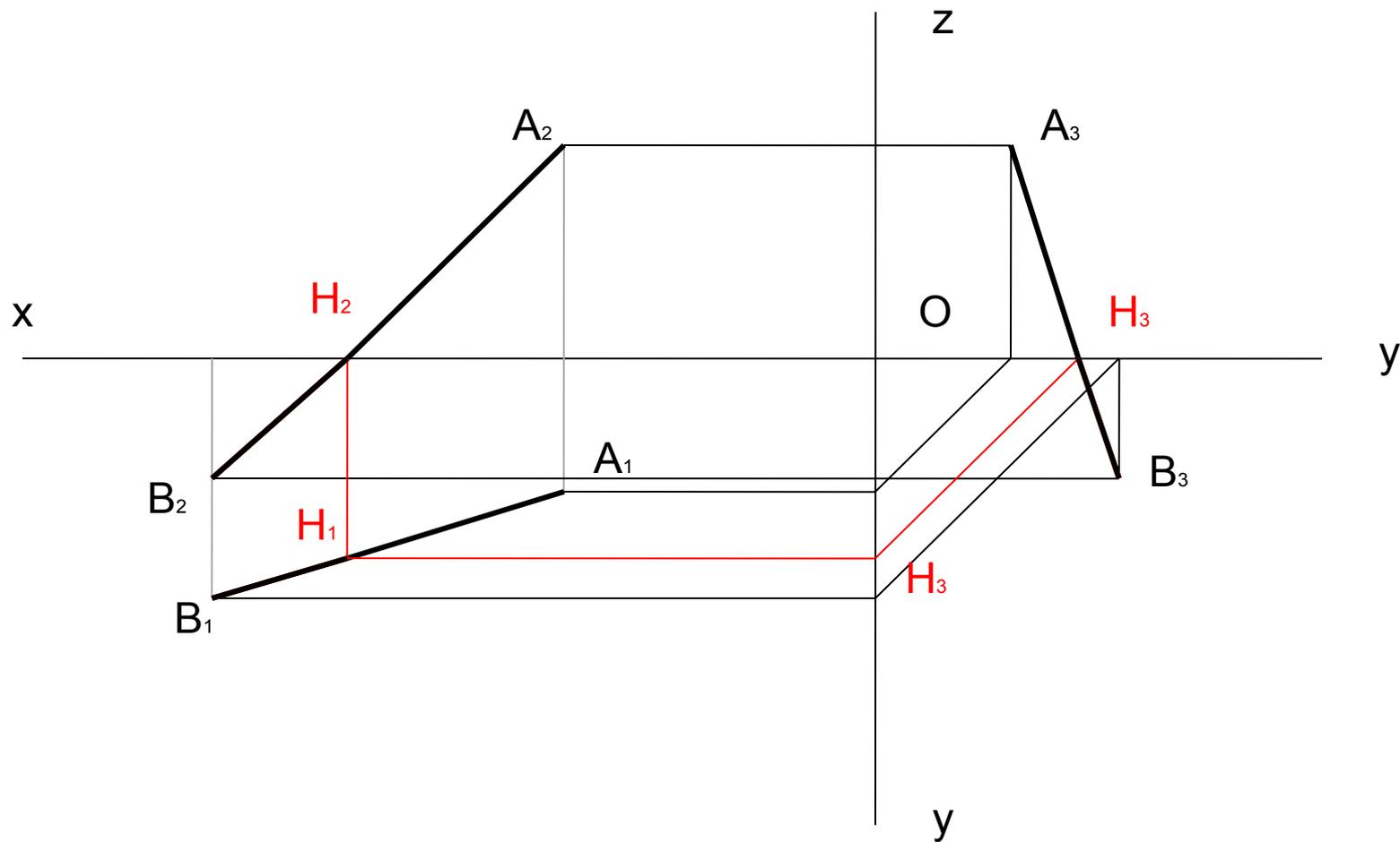
3. Определить графически алгебраическую разность координат концов заданного отрезка:  $x = x_B - x_A$   $y = y_B - y_A$   $z = z_A - z_B$
