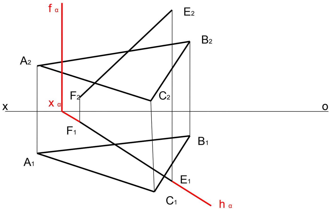
2. Найти ДК( $D_2K_2$ ,  $D_1K_1$ )линию пересечения вспомогательной пл.  $\alpha$ , ( $f \circ \alpha$  hoa) с заданной плоскостью  $\Delta ABC(A_2B_2C_2; A_1B_1C_1)$   $KD = \Delta ABC \cap \alpha$
