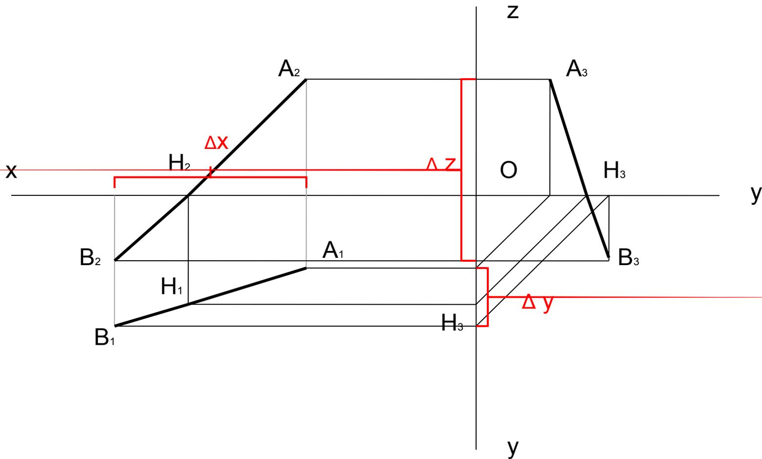
**4. Найти истинную величину отрезка и углы наклона его к плоскостям проекций**
