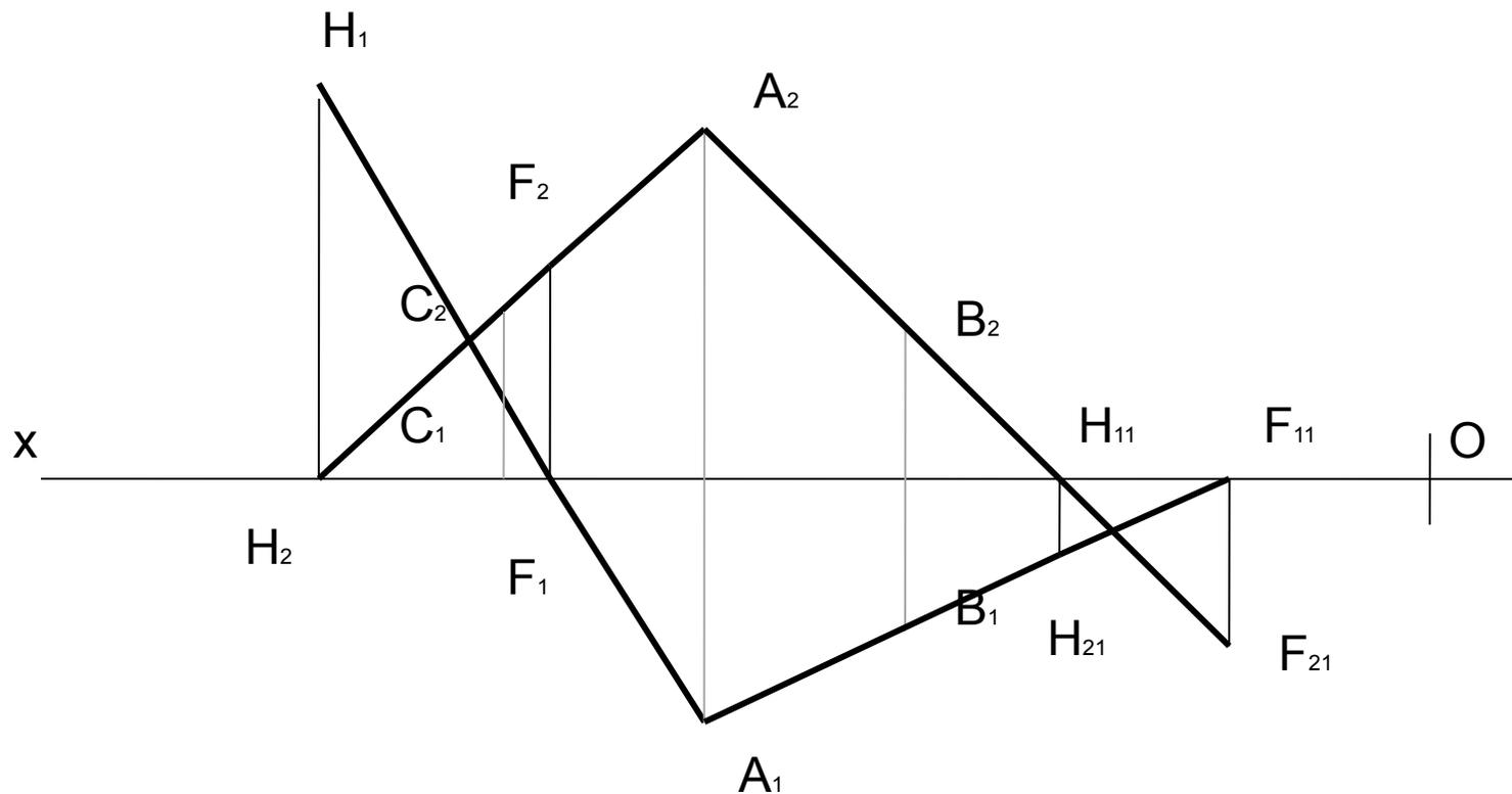
3. Через следы прямых провести соответствующие следы плоскости  $FF_1 = f_{oa}$   $H H_1 = h_{oa}$  Следы плоскостей должны пересекаться на оси  $O_x$ ;  $X_a = h_{oa} \cap f_{oa}$ ;  $X_a \in O_x$
