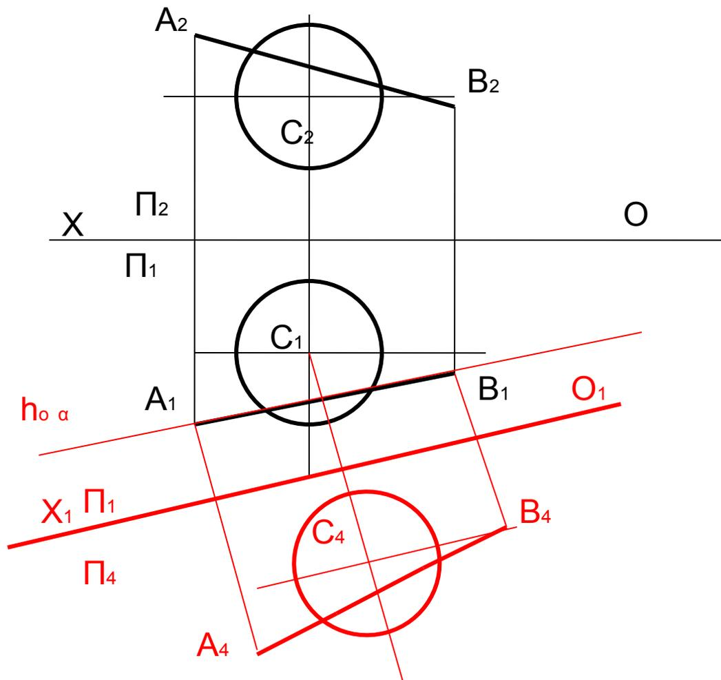
Любая плоскость пересекающая поверхность сферы, пересекает, по окружности, проекции которой при донном расположении прямой проецируются на пл. П2 в виде эллипса. Чтобы избежать построения эллипса. применим метод перемены пл. проекций, заменив пл. П<sub>1</sub> пл.П4 // A1 B1 Тогда ось O1,X1 будет // A1B1
