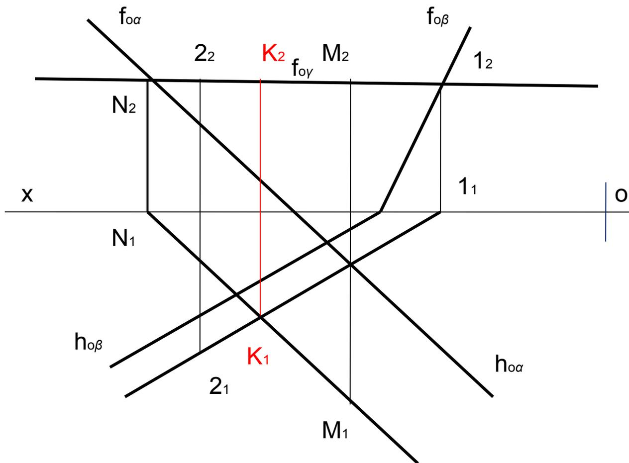
5, Определить точку  $L(L_2, L_1)$  - точку пересечения горизонтальных следов  $h_{o\alpha}$  и  $h_{o\beta}$   $h_{o\alpha} \cap h_{o\beta} = L$
