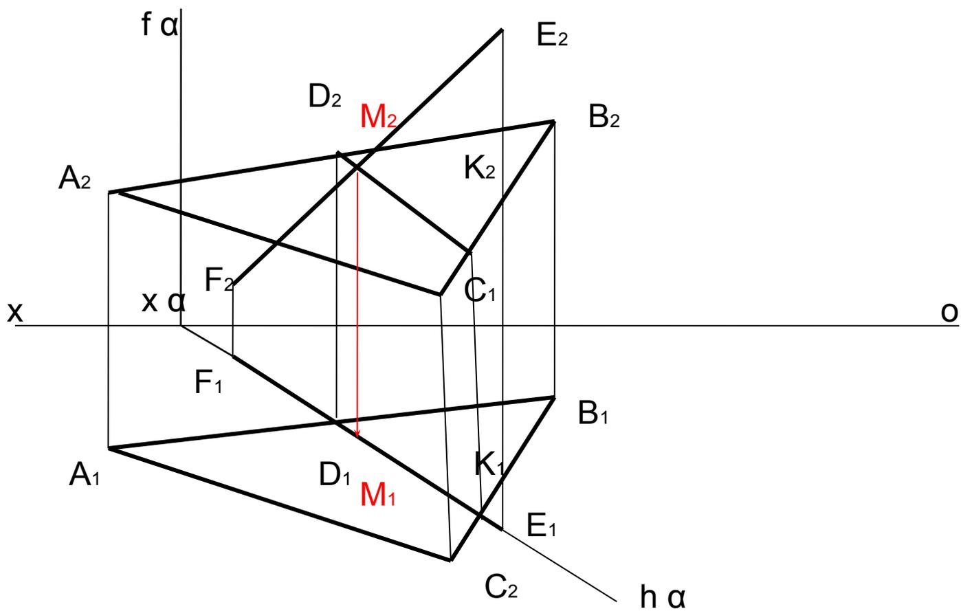
4. Используя конкурирующие точки 1( $1_21_1$ ) 2( $2_22_1$ ) Определить видимость.  $\Delta ABC$  представляет собой плоскость односторонней видимости, поэтому один и тот же участок заданной прямой будет виден сверху ( $M_1E_1$ ) и спереди ( $M_2E_2$ )
