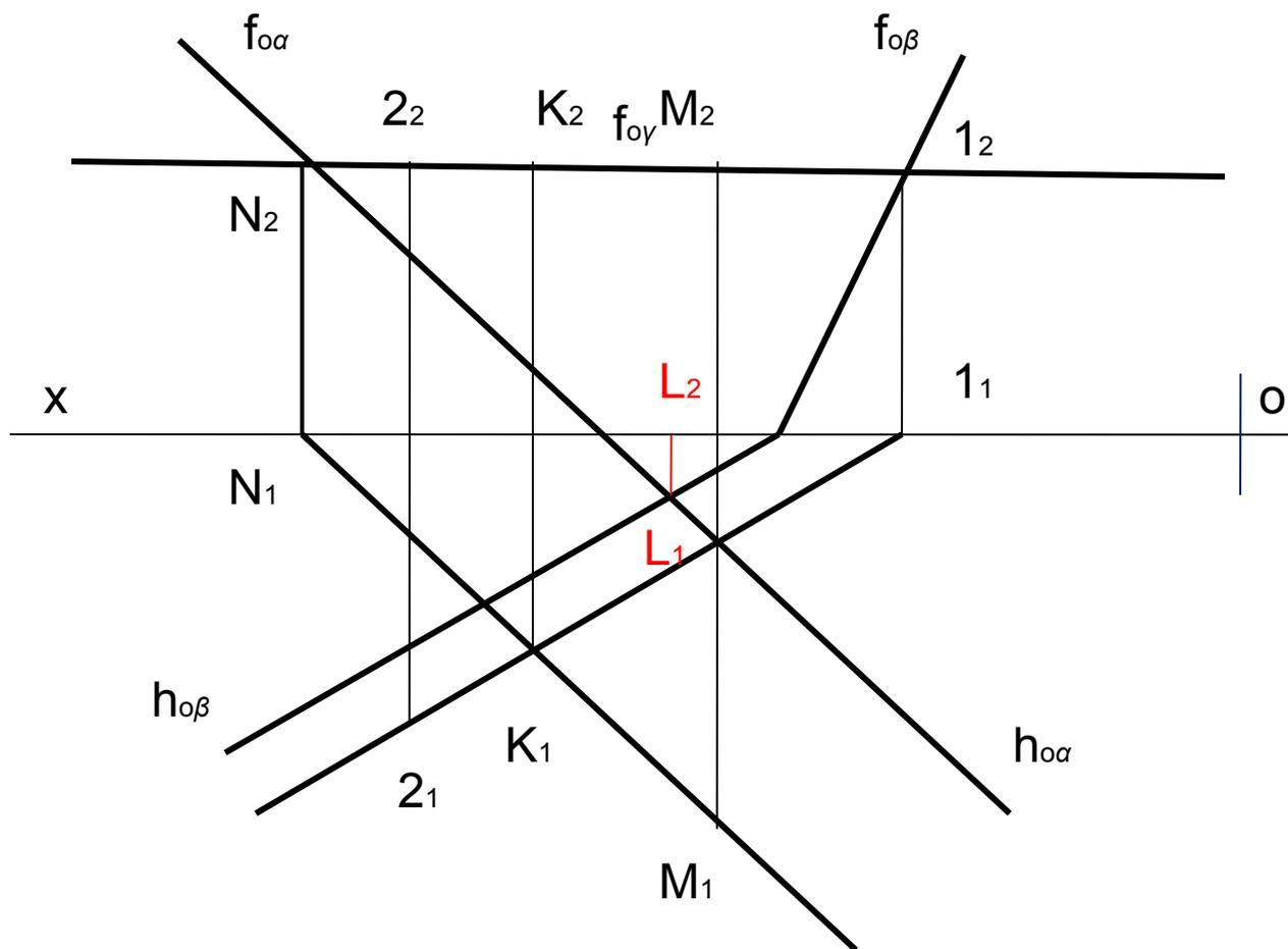
6. Определить линию KL ( $K_2L_2, K_1L_1$ )-пересечения плоскостей  $\alpha$  и  $\beta$
