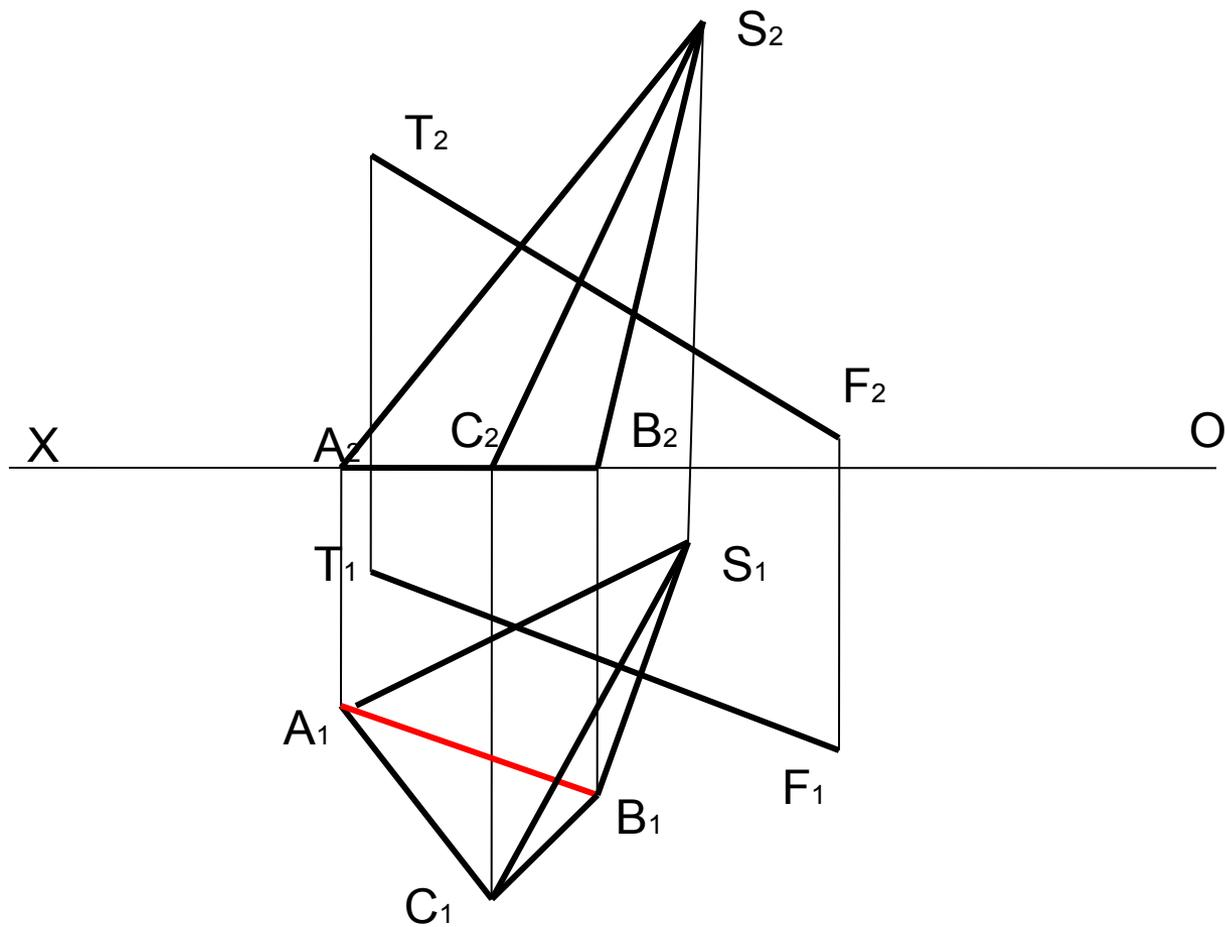
2. Через прямую  $TF$  проводим вспомогательную плоскость  $\alpha$ , перпендикулярную фронтальной плоскости проекций  $\Pi_2$ : след  $f_0 \alpha$  совпадает с  $T_2 F_2$   $h_{0\alpha} \perp$  оси  $Ox$ .
