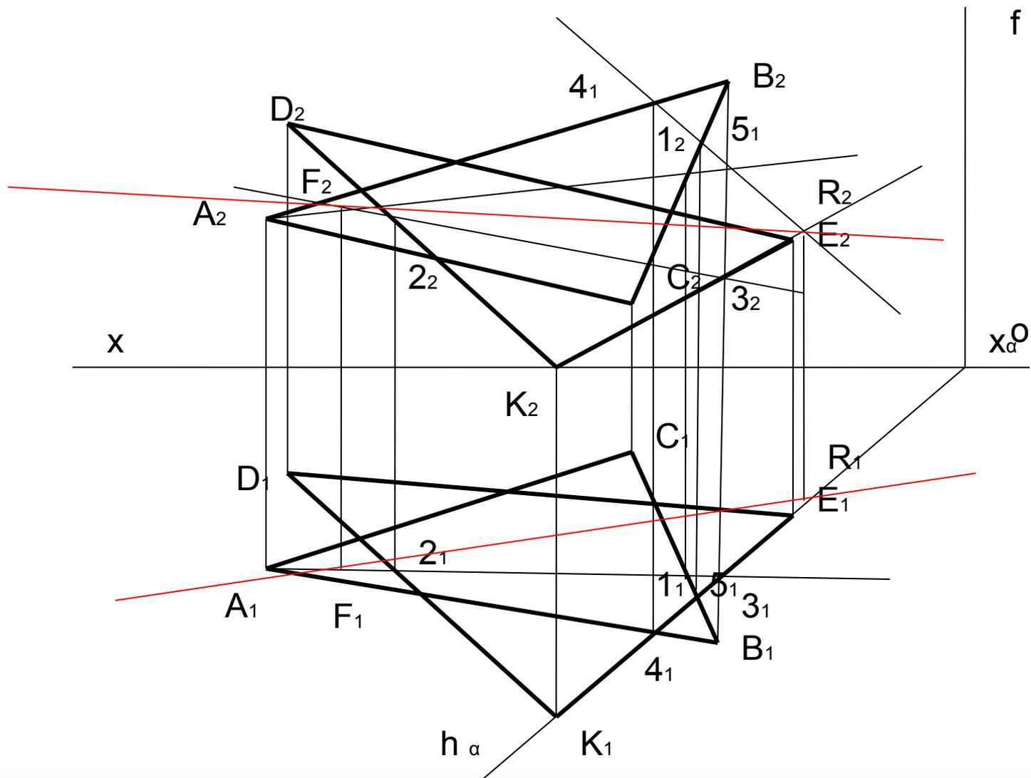
4. Пользуясь методом конкурирующих точек, определяем видимость заданных плоскостей относительно друг друга
