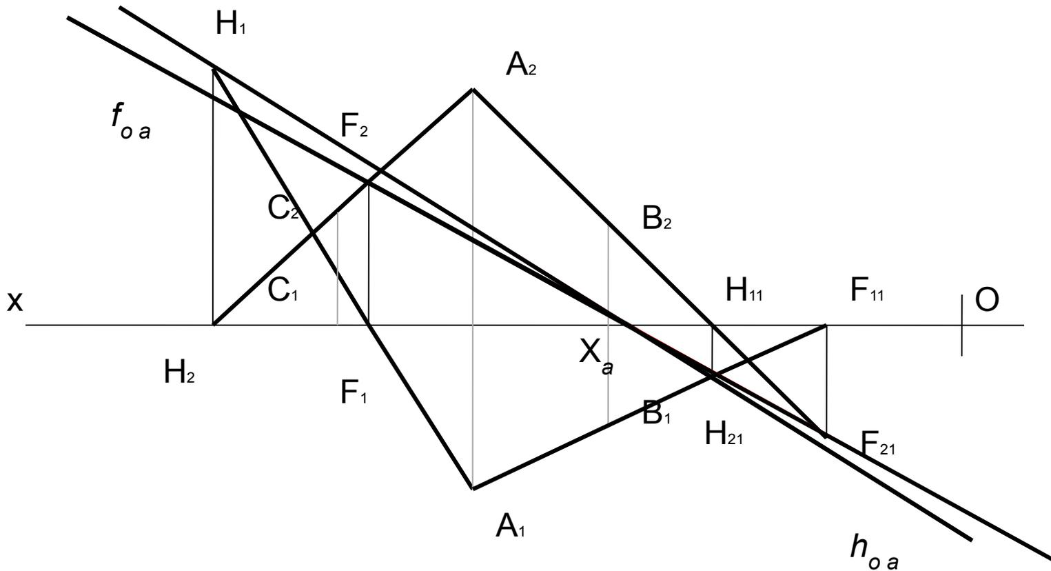
5. Провести горизонталь плоскости 1 2 ( $1_2 2_2, 1_1 2_1$ ) с отметкой  $z=5$
