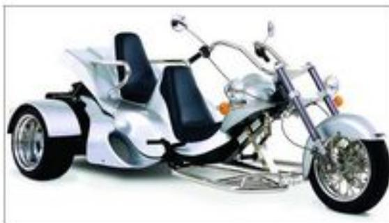
ГОСТ Р 52051-2003: «Категория L5. Трицикл. Трёхколёсное транспортное средство с колёсами, симметричными по отношению к средней продольной плоскости транспортного средства, рабочий объём двигателя которого (в случае двигателя внутреннего сгорания) превышает 50 см<sup>3</sup> и (или) максимальная конструктивная скорость (при любом двигателе)
