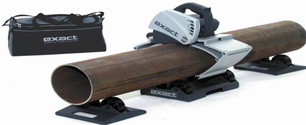
**Exact 360** Труборез для работы на стройке и в цехе, для быстрой, точной резки труб диаметром от 75 до 360 мм и толщиной стенки до 25мм (для пластиковых труб). Подходит для резки труб всех материалов: стальных, нержавеющей, медных, алюминиевых, чугунных и пластмассовых.
