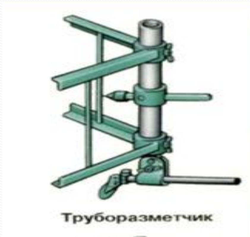
Труборазметчик - для разметки конфигурации реза при изготовлении сварных отводов тыковки труб под углом
