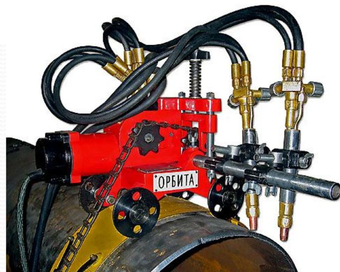
Газорезательная машина «Орбита»
