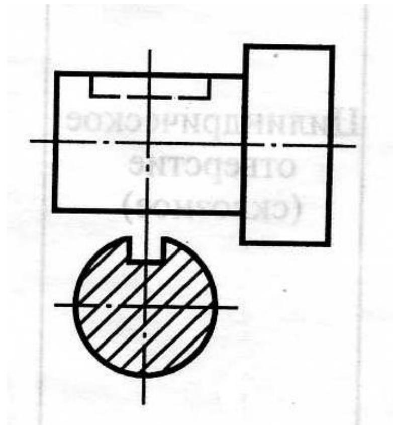
При расположении фигуры сечения на свободном поле чертежа сечение **обозначается:**
