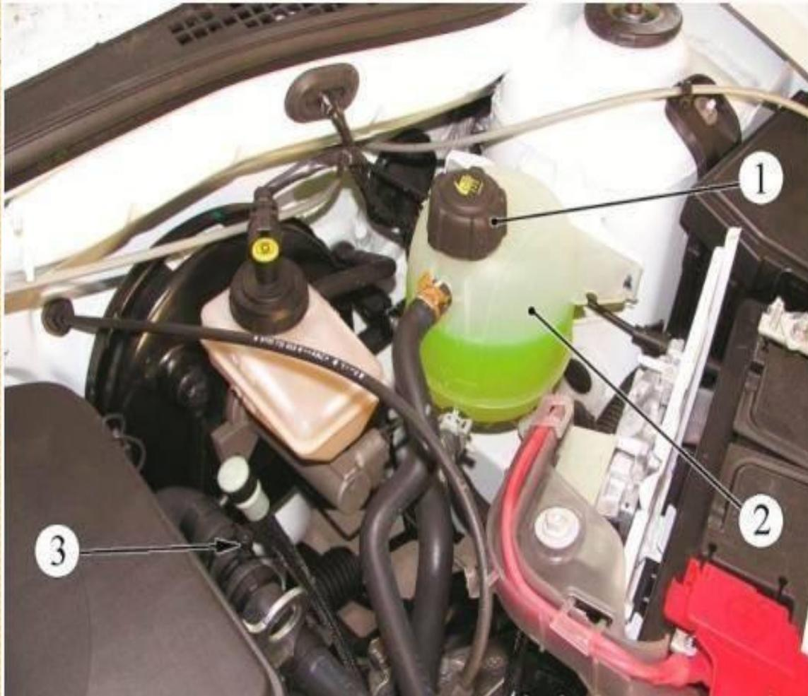
Вследствие изменения температуры охлаждающей жидкости меняется и её объем. Чтобы компенсировать его, в систему охлаждения встраивается расширительный бачок, поддерживающий объем жидкости в системе на одном уровне.
