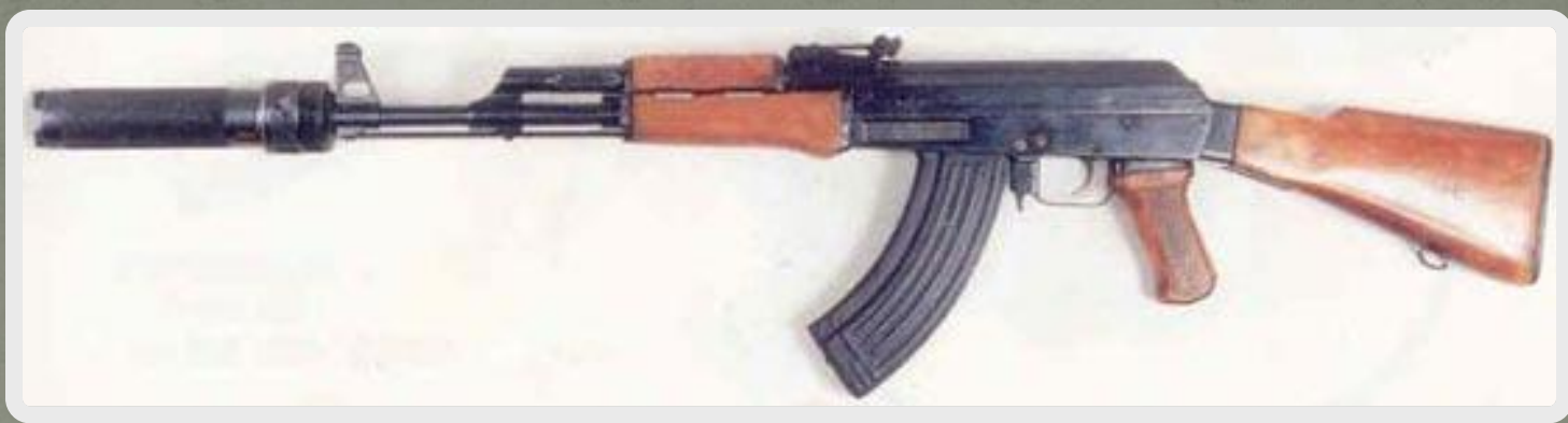
Серийный автомат Калашникова АК выпуска после 1951 года, укомплектованный глушителем ПБС-1
