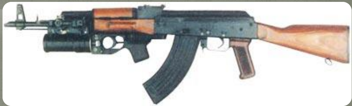
автомат Калашникова модернизированный АКМ с установленным подствольным 40-мм гранатометом ПП-25
