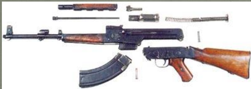
Опытный автомат Калашникова АК-46, неполная разборка
