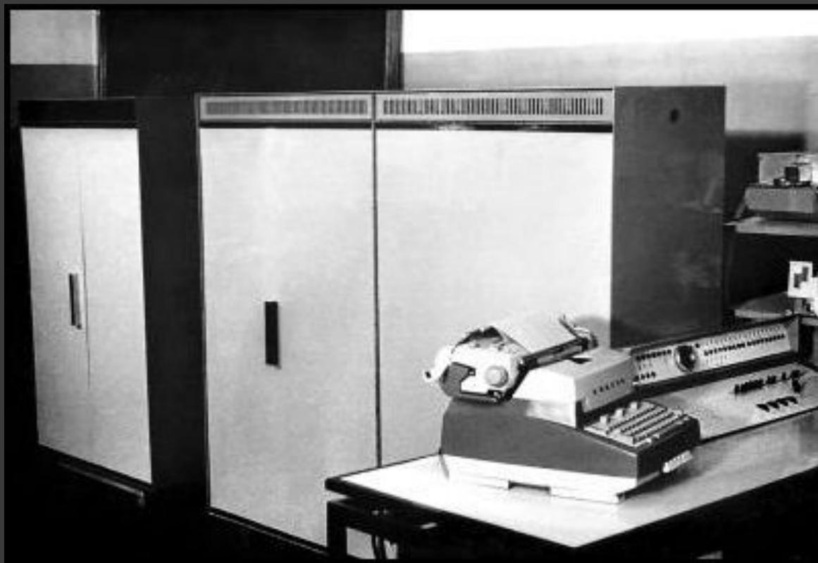
Троичный компьютер — компьютер, построенный на двоичных и троичных логических элементах и узлах, работающий в двоичной и троичной системе счисления по законам двоичной и троичной логики с применением двоичных и троичных алгоритмов.
