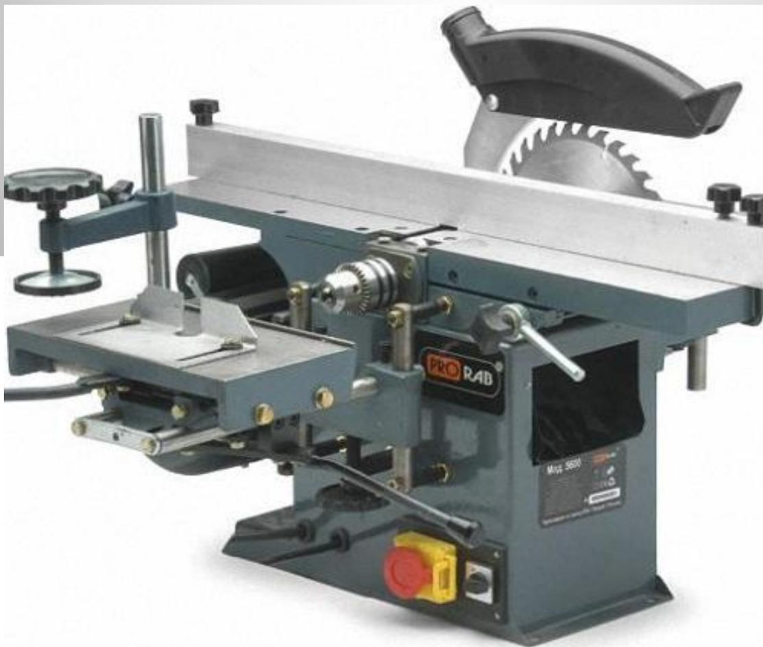
В качестве станины используется тяжеловесное сооружение, выполненное из чугуна. Все конструктивные части станка устанавливаются на станину. Она отвечает за их месторасположение и за устойчивость устройства. Чугун получил широкое распространение как конструкционный материал в машиностроительной, металлургической и других отраслях промышленности в связи с рядом преимуществ перед многими материалами, среди которых основные - невысокая стоимость и хорошие литейные свойства.
