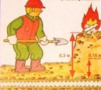
С глубины 0,3 м ниже копайте лопатой. Применять ломы, кирки, отбойные молотки ЗАПРЕЩАЕТСЯ!
