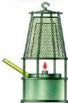
Убедитесь, что лампа заправлена бензином и опломбирована. Проверьте исправность сетки и герметичность (продувкой сжатым воздухом от аппарата АП-2)
