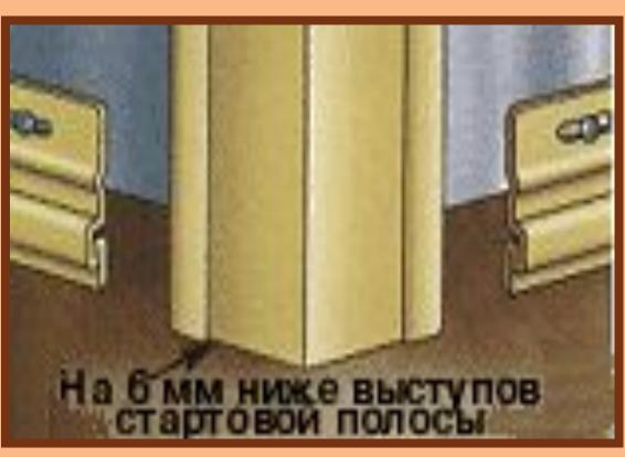
Установите внешний угол, оставляя сверху расстояние в 6 мм до карниза или Ј-рейки. Прикрепите деталь, забив гвозди в верхние отверстия по обе стороны детали. Деталь должна висеть на этих двух гвоздях
