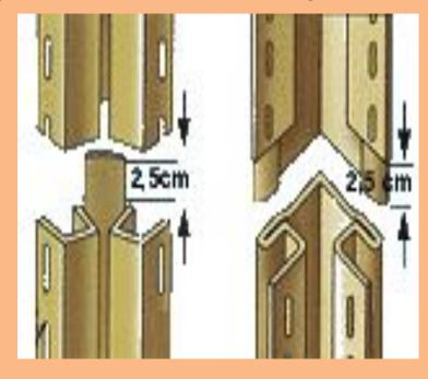
Внутренний угол устанавливается на существующем стыке двух стен, на 6 мм ниже края стартовой полосы. Оставьте сверху расстояние до карниза, достаточное для установки софита. Прикрепите деталь, забив гвозди в верхние отверстия по обе стороны детали. Деталь должна висеть на этих двух гвоздях
