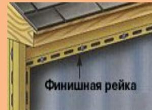
Установите деталь верхней кромки под окном по ширине проема заподлицо с рамой. Иногда необходимо прибить рейки, чтобы сайдинг плотнее прилегал к стене. Используя пассатижиперфоратор, проделайте выступы в панели на 6 мм ниже обреза с интервалом в 17-20 см. Образовавшиеся выступы должны быть лицевой стороной наружу и затем закладываются под верхнюю кромку сайдинга.
