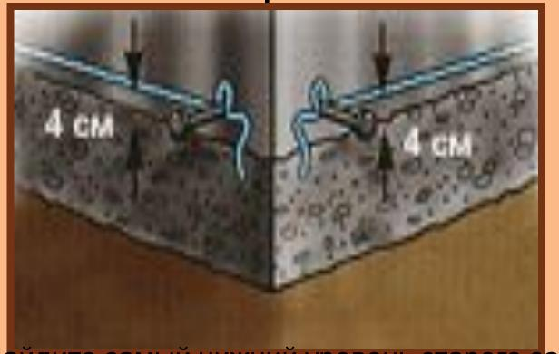
Найдите самый нижний уровень старого сайдинга или другой облицовки на стене дома. Частично вбейте гвоздь на 3,8-4,0 см выше, чем нижний уровень. Вбейте таким же образом гвоздь на другом углу стены. С помощью бичевки и мела отбейте на стене ровную прямую линию между гвоздями. Повторите эту процедуру вокруг всего дома.
