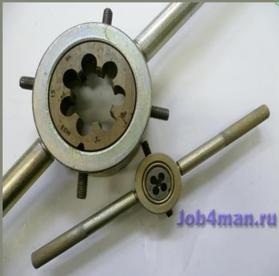
Все плашки используются совместно с плашкодержателями – инструмент для зажима, подходит сразу под несколько диаметров плашек. Например, для маленьких (до 10мм), для средних (от 12мм до 24мм), для больших размеров (27мм-42мм). Плашка ставится внутрь держателя и затягивается винтом, под винт имеется специальная выемка.
