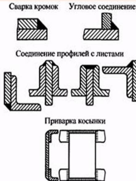
Для укладки швов выполнено смещение свариваемых деталей
