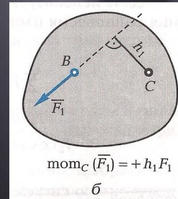
**Моментом силы  $F$**  относительно некоторого центра  $O$  называется величина, равная произведению силы на кратчайшее расстояние от точки  $O$  до линии действия силы и взятая с соответствующим знаком.
