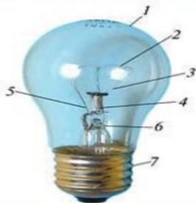
Схема электрической лампы накаливания: 1 - стеклянная колба; 2 - нить накаливания; 3 - держатели; 4 - штенгель; 5 - выводы; 6 - лопатка; 7 - цоколь.
