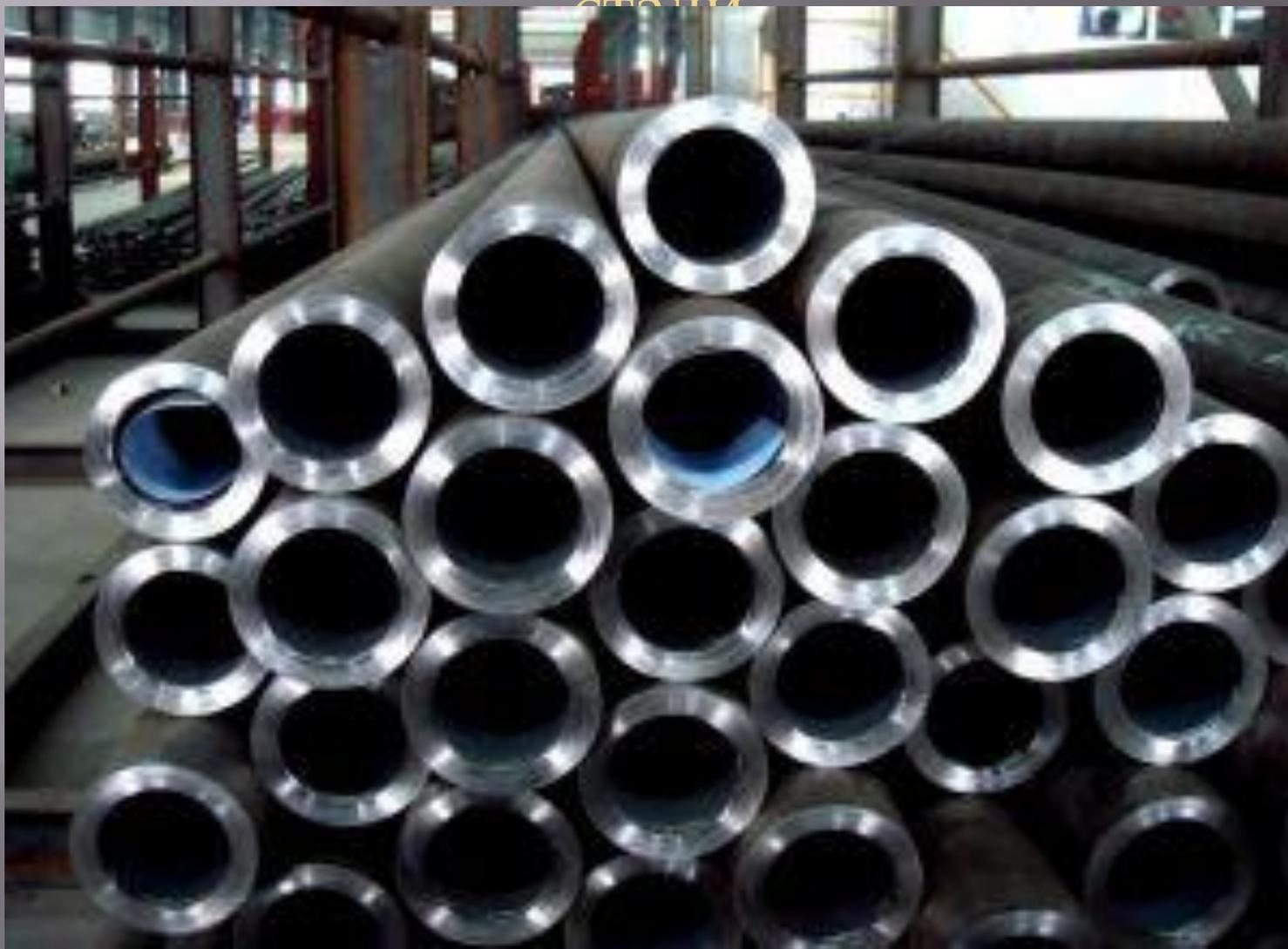
*Стали перлитного класса* используют для изготовления крепежа, труб, паропроводов, пароперегревателей и коллекторов энергетических установок, длительно работающих при температурах 500 - 550 С. Стали этого класса используют в закаленном или нормализованном и высокоотпущенном состоянии.
