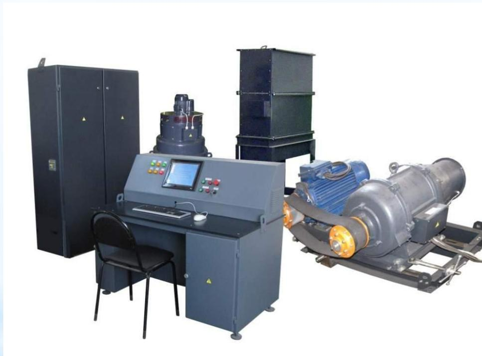
При нормальной работе двигателя в течение 20...30 мин с механизмом далее продолжается его обкатка вместе с механизмом не менее 8 ч. При этом прирабатываются подвижные детали механизмов, проверяется на нагрев электрооборудование, выявляются его слабые места.
