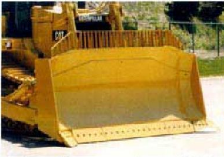
Полусферический отвал с козырьком бульдозера D8R Caterpillar
