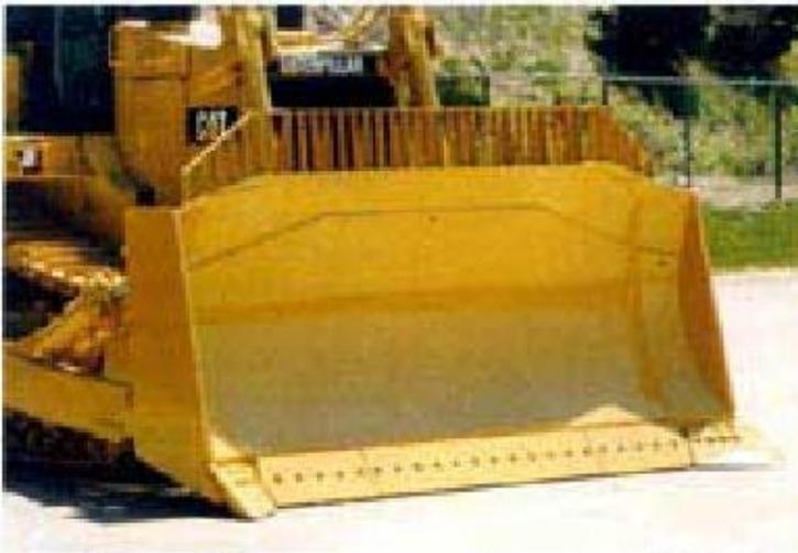
Полусферический отвал с козырьком бульдозера D8R Caterpillar
