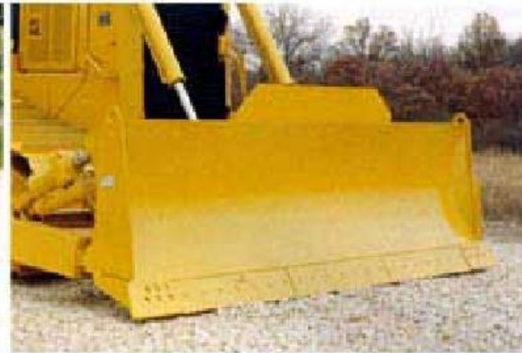
Прямой неповоротный отвал бульдозера D8R Caterpillar
