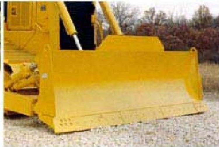
Прямой неповоротный отвал бульдозера D8R Caterpillar
