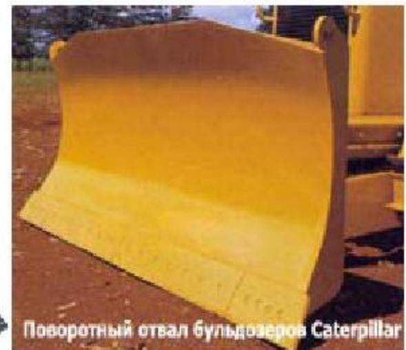
Поворотный отвал бульдозеров Caterpillar
