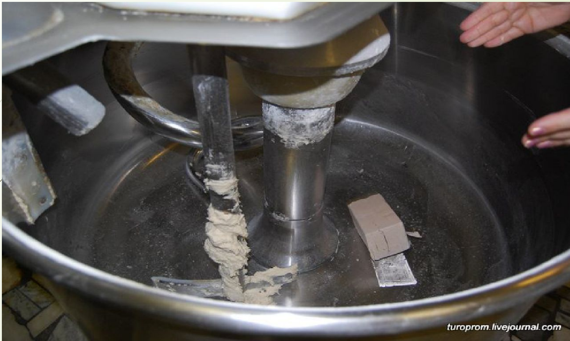
Специальная машина тестомешалка, замешивает тесто.
