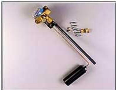
Мультиклапан монтируется на горловину баллона. Включает в себя заправочный и расходный клапана, указатель уровня газа и заборную трубку. Специальный скоростной клапан перекрывает утечку газа при аварийном повреждении газовой магистрали.
