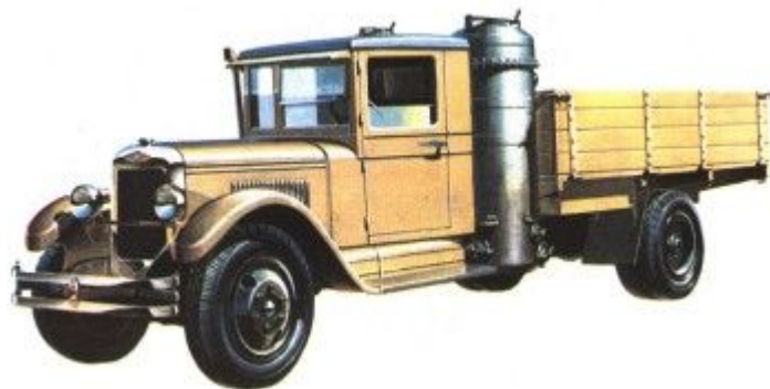
ГАЗ-А с газогенераторной установкой "Автодор-3". 1935 г.
