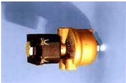
Электромагнитный газовый клапан служит для перекрытия газовой магистрали при стоянке или работе двигателя на бензине. Снабжен фильтром для очистки топливной смеси
