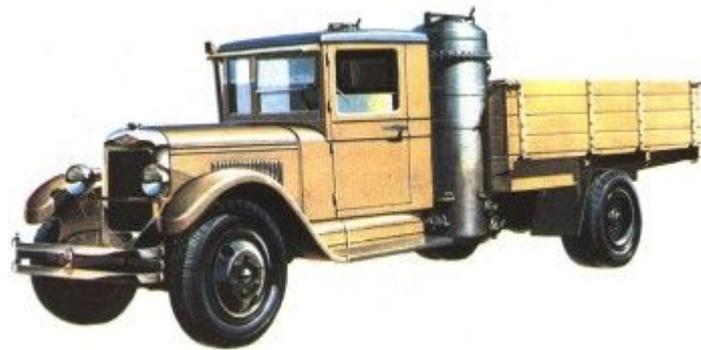
ГАЗ-А с газогенераторной установкой "Автодор-3". 1935 г.
