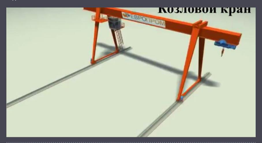
У большинства кранов мост опирается на опоры - стойки, в пролётной части которых транспортируется груз.
