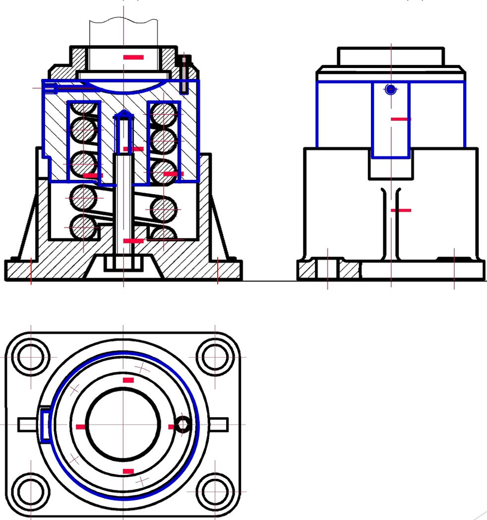
На виде слева дочерчиваем наружный контур, отображая фаску упрощённую на чертеже общего вида.
