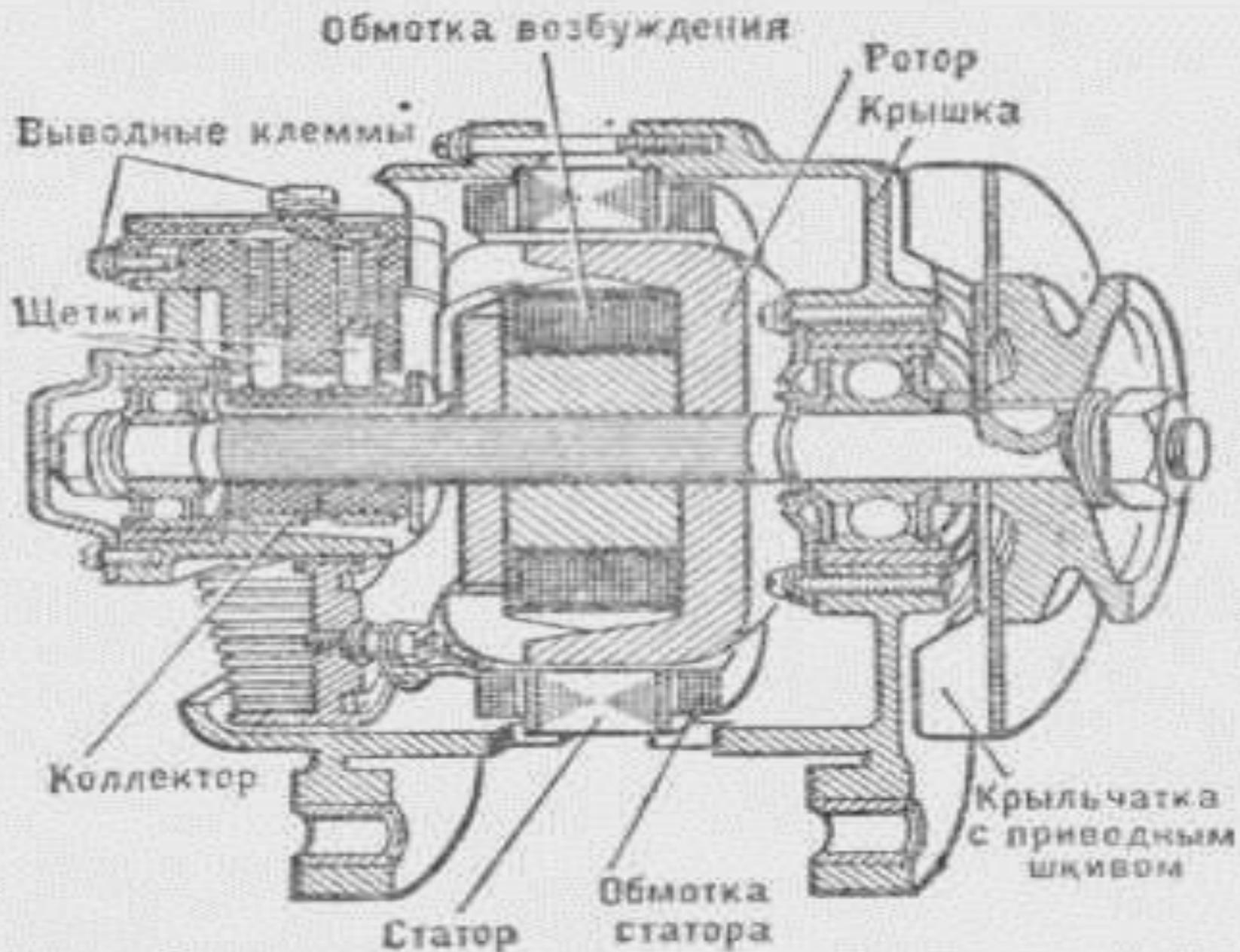
Рис. 76. Генератор переменного тока
