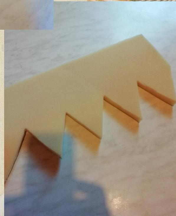
**3. Промазываем клеем противоположные торцы детали — тщательно, без пропусков. И, дав подсохнуть промазанному краю 1-2 мин, соедините их встык.**
