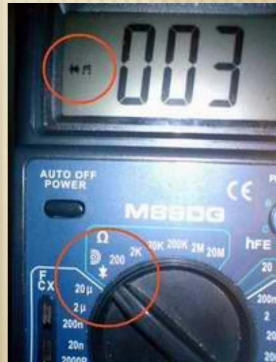
Режим прозвонки в цифровом тестере
