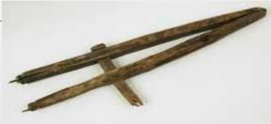
Циркуль знаком каждому человеку со школы - на уроках черчения нельзя обойтись без этого инструмента для рисования окружностей и дуг. Кроме того, его используют для измерения расстояний, например, на картах, его применяют в геометрии и для навигации. Обычно циркуль делается из металла и состоит из двух «ножек», на конце одной из них находится игла, на второй пишущий предмет, обычно графитный грифель. В случае если циркуль измерительный, на обоих его концах расположены иглы.
