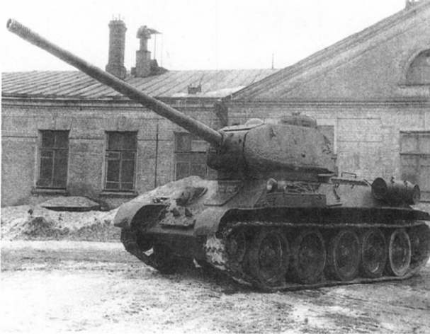
Танк Т-34-100 с орудием ЗИС-100 в штатной башне танка Т-34-85. 1945 год.
