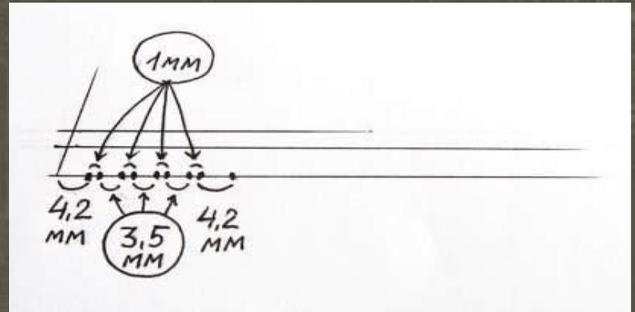
4. Проводим через отмеченные точки с помощью линейки и треугольника (или двух треугольников) тонкие бледные серые линии под углом  $75^\circ$  к основанию строки параллельно той линии, которая была изображена на предыдущем этапе построения.
