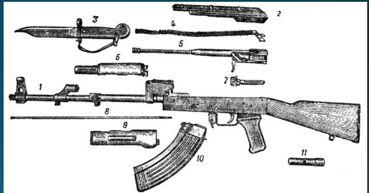
Рис. 2. Основные части и механизмы автомата: 1 — ствол со ствольной коробкой, с прицельным приспособлением и прикладом; 2 — крышка ствольной коробки; 3 — штык-нож; 4 — возвратный механизм; 5 — затворная рама с газовым поршнем; 6 — газовая трубка со ствольной накладкой; 7 — затвор; 8 — шомпол; 9 — цевье; 10 — магазин; 11 — пенал с принадлежностью
