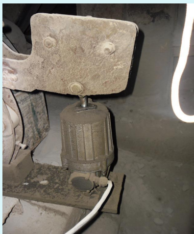
гидротолкатель ТЭ-50 горизонта – 90 м Привод тормоза электродвигателя вагон опрокидывателя
