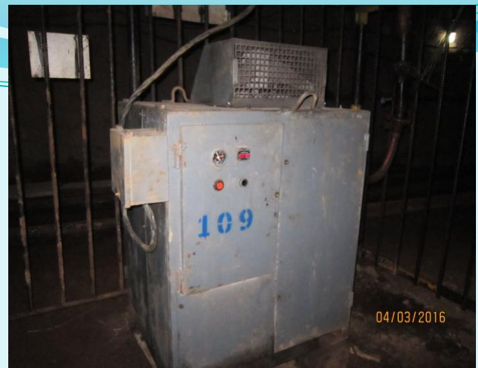
компрессор SECCATO-40 горизонт-90м
