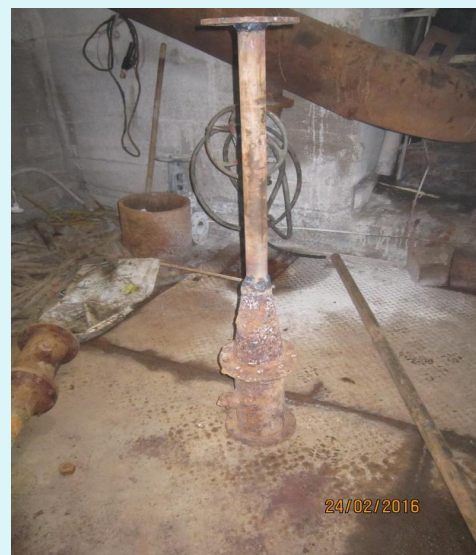
гидротолкатель ТЭ-50 горизонта – 90 м Привод тормоза электродвигателя вагон опрокидывателя
