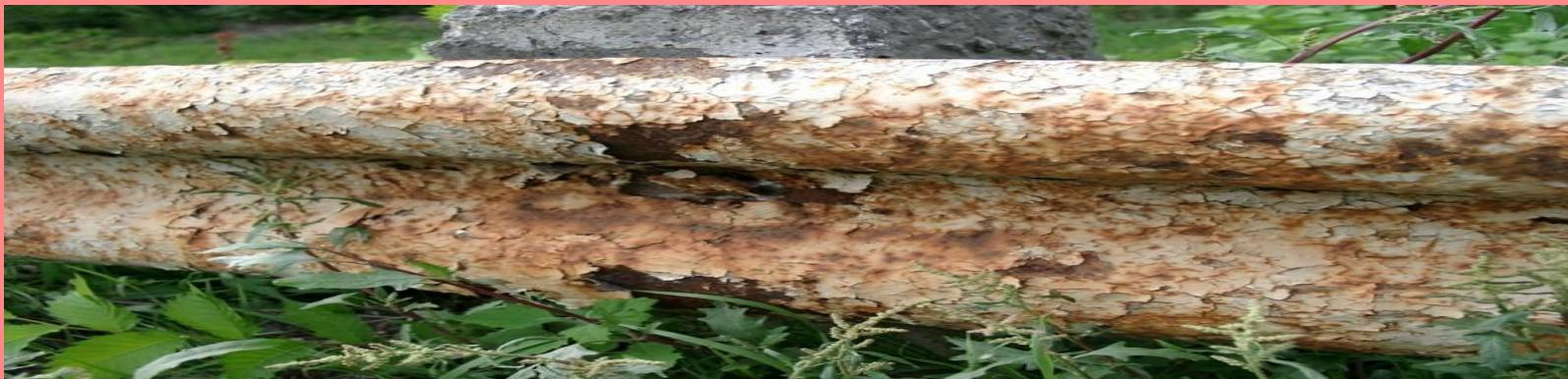
Для защиты изделий от коррозии применяют защитные покрытия, электрохимическую защиту и замедлители коррозии (ингибиторы), изменяющие состав коррозийной среды. В строительной практике чаще используют лакокрасочные и другие покрытия поверхности.
