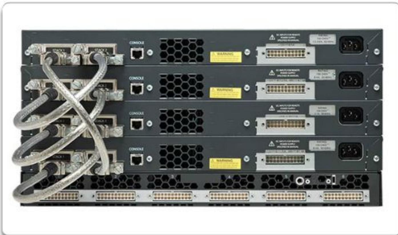
Стекируемые коммутаторы, подключенные по специальному кабелю, эффективно функционируют как один большой коммутатор.
