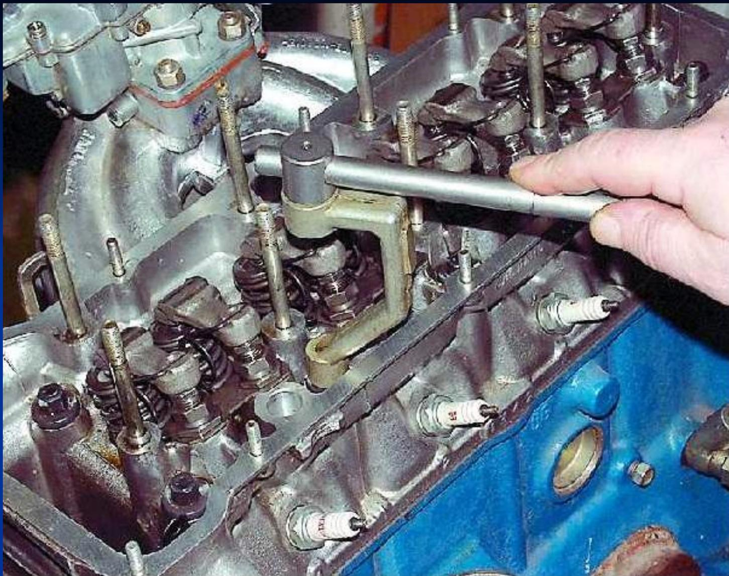
Отверните болты крепления головки блока цилиндров
