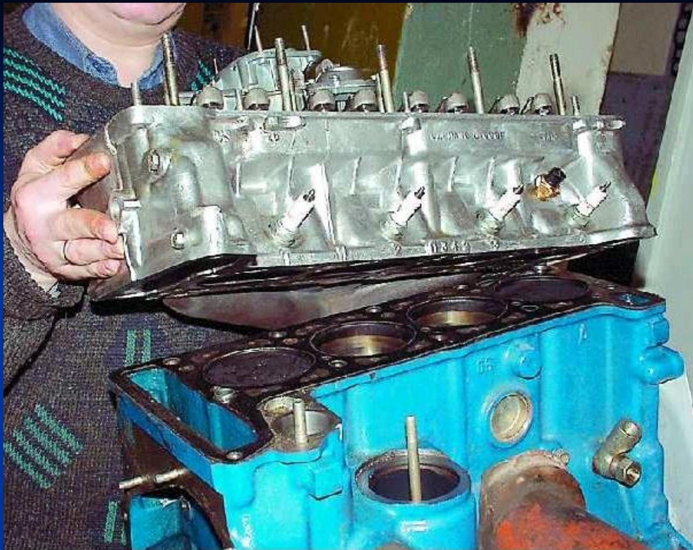
Снимите головку блока цилиндров.
