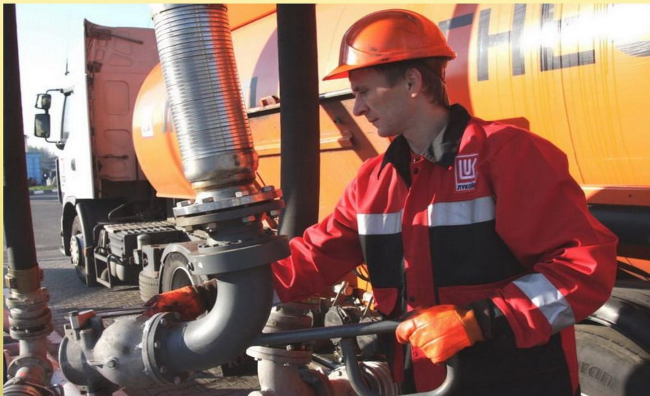
**Налив нефтепродуктов осуществляется, как правило, по закрытой бесшланговой системе автоматизированных шарнирно-сочлененных или телескопических устройств, оборудованных автоматическими ограничителями налива, обеспечивающими предотвращение перелива цистерн, а также устройствами для герметизации налива с отводом паров на регенерационную установку или газосборную систему.**
