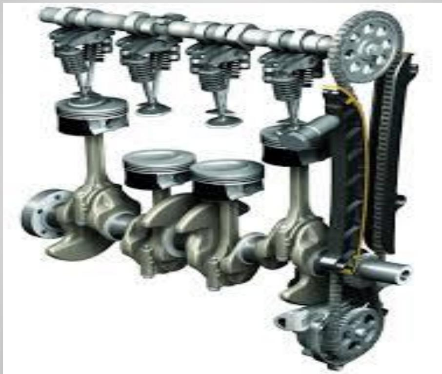
Предназначен для обеспечения своевременной подачи в цилиндры двигателя воздуха или топливно-воздушной смеси (в зависимости от типа двигателя) и выпуска из цилиндров отработавших газов. Данные функции реализуются за счет своевременного открытия и закрытия клапанов
