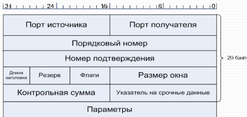
Рис. Формат заголовка сегмента TCP
