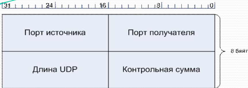
Рис. Формат заголовка пакета UDP.
