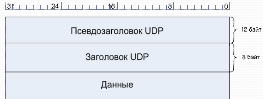
Рис. Структура пакета UDP при вычислении контрольной суммы.
