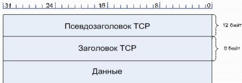
Рис. Структура пакета TCP при вычислении контрольной суммы
