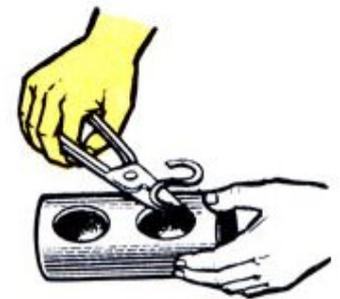
Для прямолинейной резки металл небольшой толщины применяют ручные ножницы, одну рукоятку которых зажимают в тисках:
