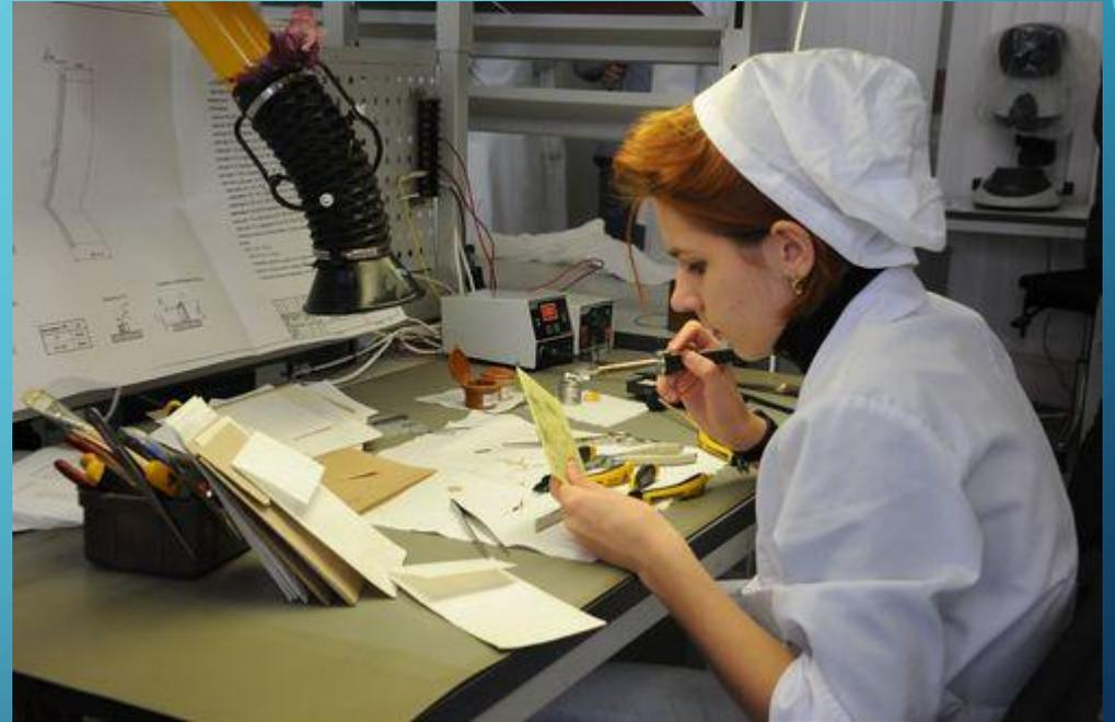
Работает монтажник РЭА и П сидя, в спецодежде (халат белого цвета), на специально оборудованном рабочем месте с полным набором монтажного инструмента и измерительной техники. Основные инструменты монтажника радиоэлектронной аппаратуры – паяльник, паяльная станция, плоскогубцы, пинцет, бокорезы.
