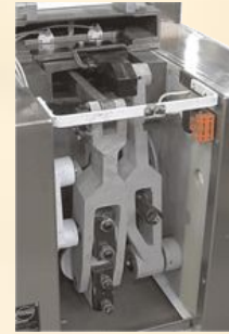
Механизм привода ножа и поршня
