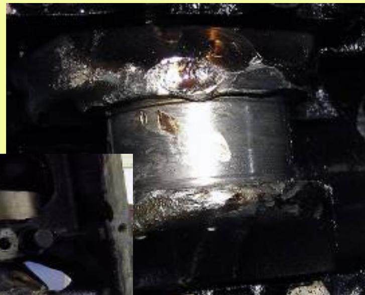
Без смазки проворачиваются подшипники и шатун заклинивает
