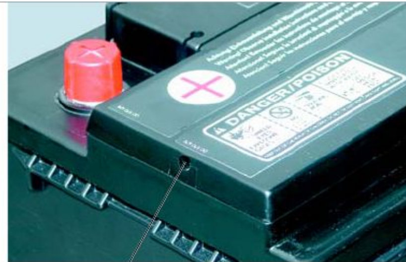
Отверстия центральной системы вентиляции
