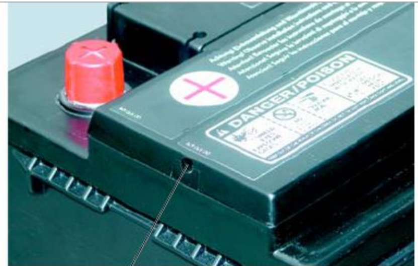
Отверстия центральной системы вентиляции
