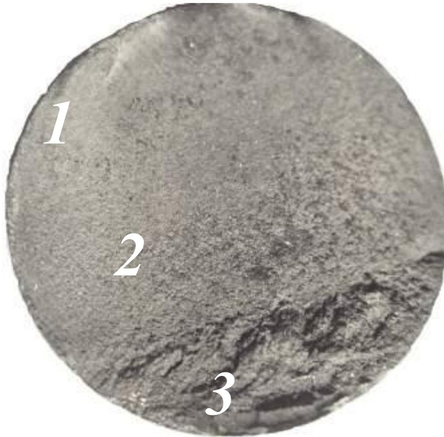
*1* — очаг зарождения трещины; *2* — излом;
