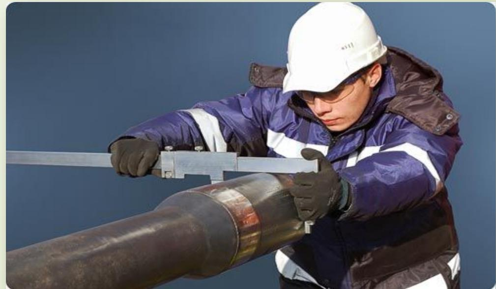
**Шаблон Ушерава- Маршака**, предназначенный для измерения скоса кромок при подготовке свариваемых соединений деталей, измерения высоты катета углового шва, измерения высоты валика усиления, измерения выпуклости корня шва стыкового сварного соединения, измерения зазора в соединении при подготовке деталей к сварке
