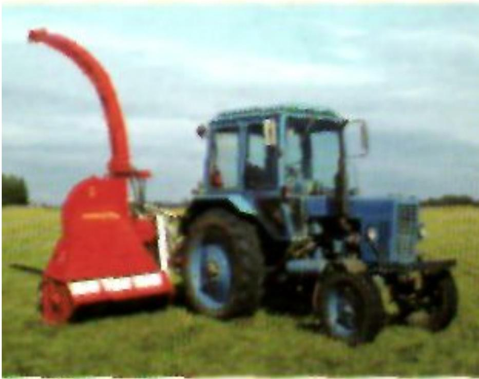
Чтобы клубни лучше и быстрее вызревали, а уборочная техника лучше работала, перед уборкой удаляют ботву двумя способами: 1) скашиванием 2) химической обработкой.
