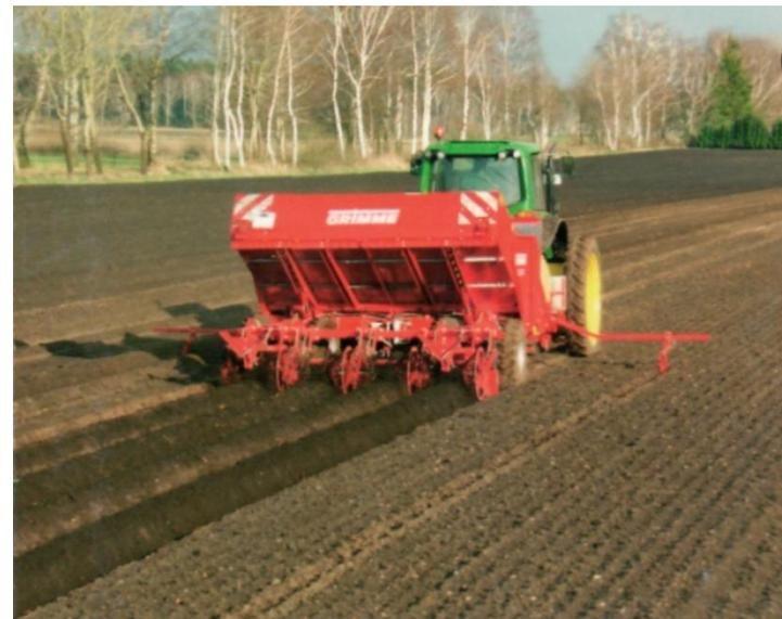
**Глубина и способ посадки.** В Нечерноземной зоне основной способ посадки – в предварительно нарезанные гребни с междурядьями 70 см. Картофель сажают картофелесажалками СН -4Б, КСМ -4 и КСМ -6. Скорость движения агрегата 4,5-6 км/ч. Клубни на суглинистых почвах заделывают на глубину 6-8 см.
