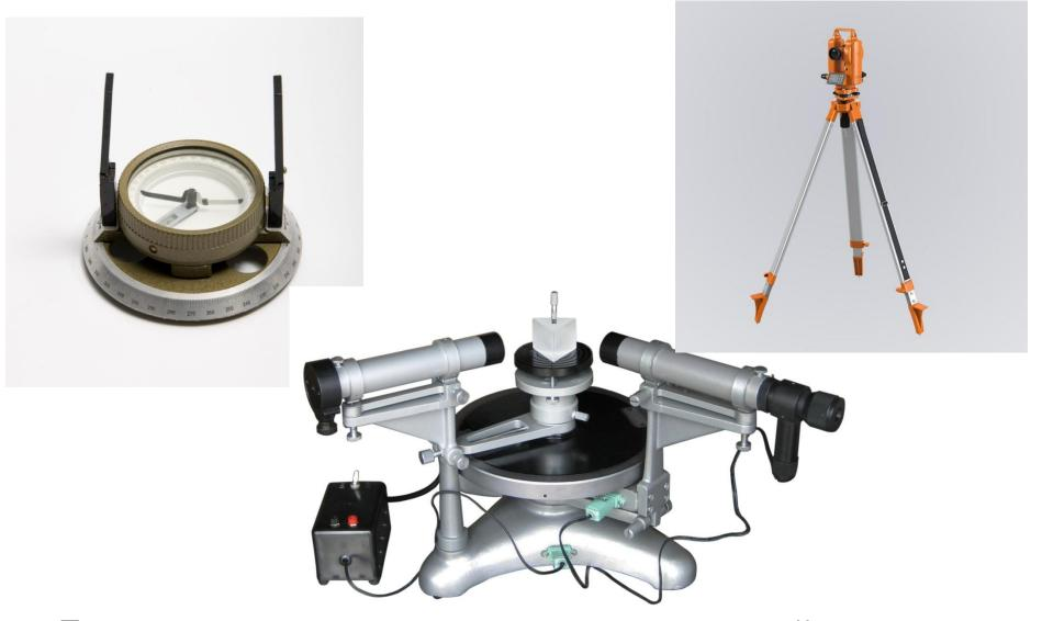
• Для съемки участка применяют простейшие угломерные инструменты - буссоль, гониометр, теодолит.
