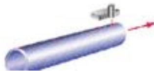
Сварка наружного шва Outside welding
