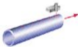
АУЗК шва (сдаточный) Weld final UT
