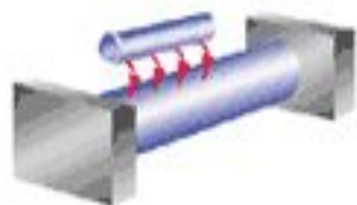
Калибрование и гидроиспытание Sizing; Hydrostatic test
