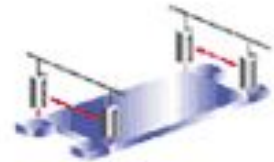
Приварка технологических планок TAB Welding-up
