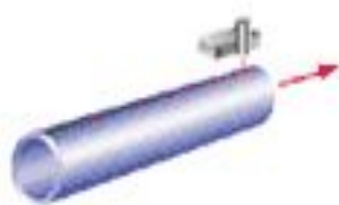
АУЗК шва (сдаточный) Weld final UT
