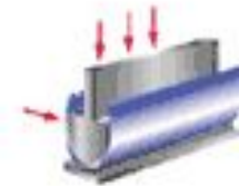
Предварительная формовка трубной заготовки U-forming
