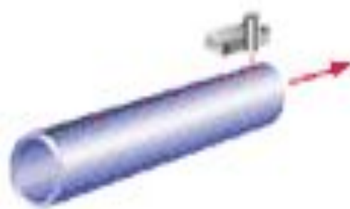
АУЗК шва (сдаточный) Weld final UT
