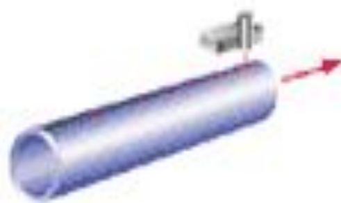
АУЗК шва (сдаточный) Weld final UT
