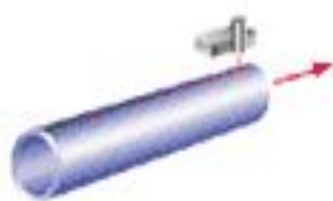
АУЗК шва (сдаточный) Weld final UT
