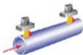
Магнитолуминесцентный контроль MPI of pipe ends
