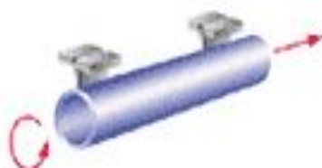
АУЗК концов трубы по периметру End AUT
