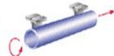
АУЗК концов трубы по периметру End AUT
