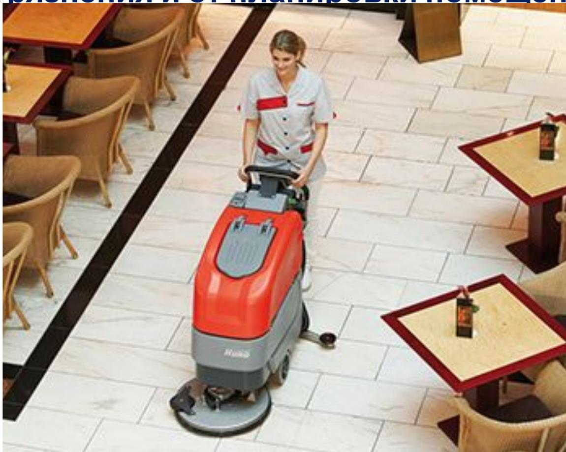
**Все поломоечные машины можно разделить на три группы: сетевые поломоечные машины, аккумуляторные поломоечные машины и поломоечные машины с двигателем внутреннего сгорания.**
