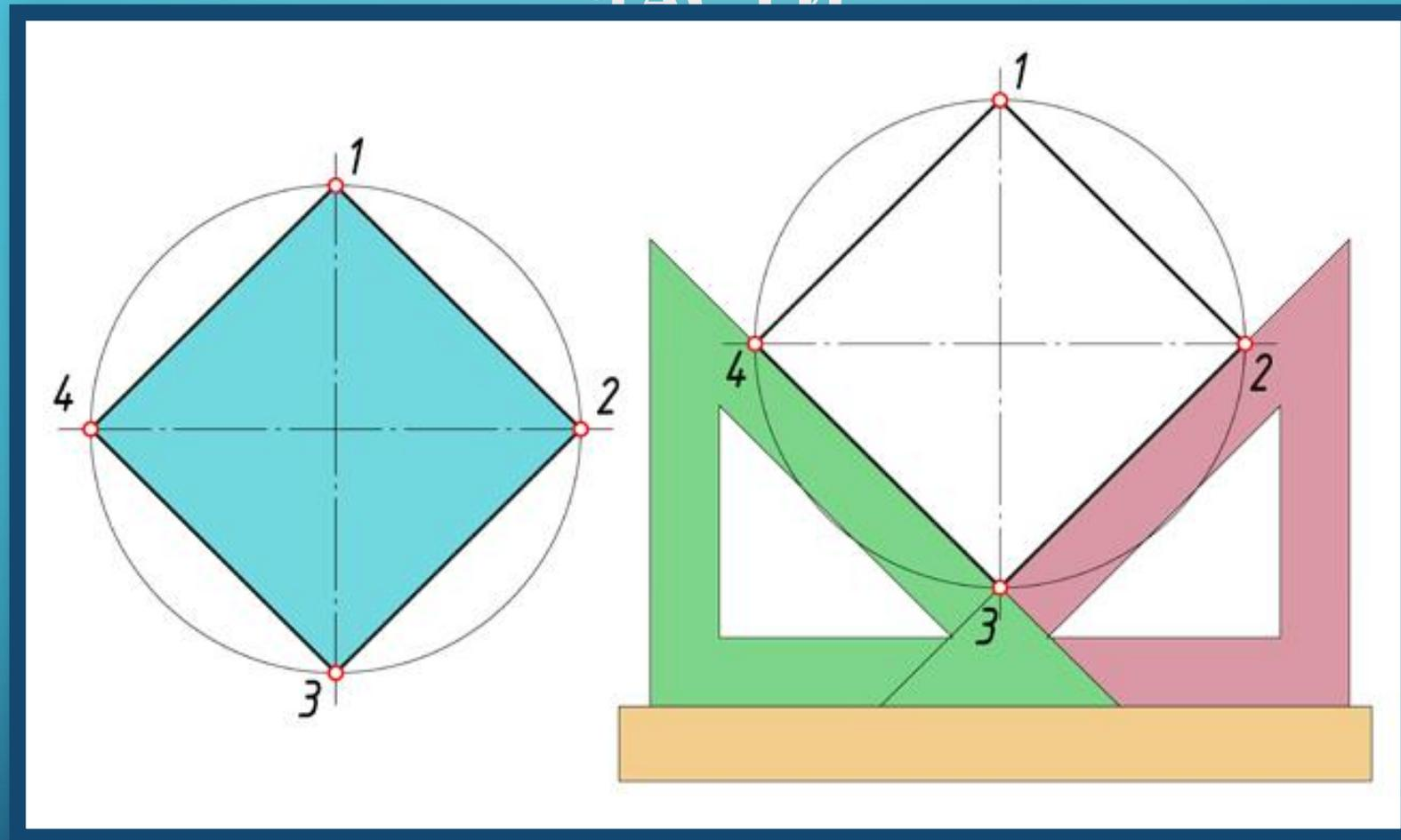
Чтобы разделить окружность на 4 равные части, нужно провести два взаимно перпендикулярных диаметра окружности (13, 24). То же самое можно выполнить с помощью угольника 45°. Гипотенуза угольника должна проходить через точки пересечения центральных линий и окружности
