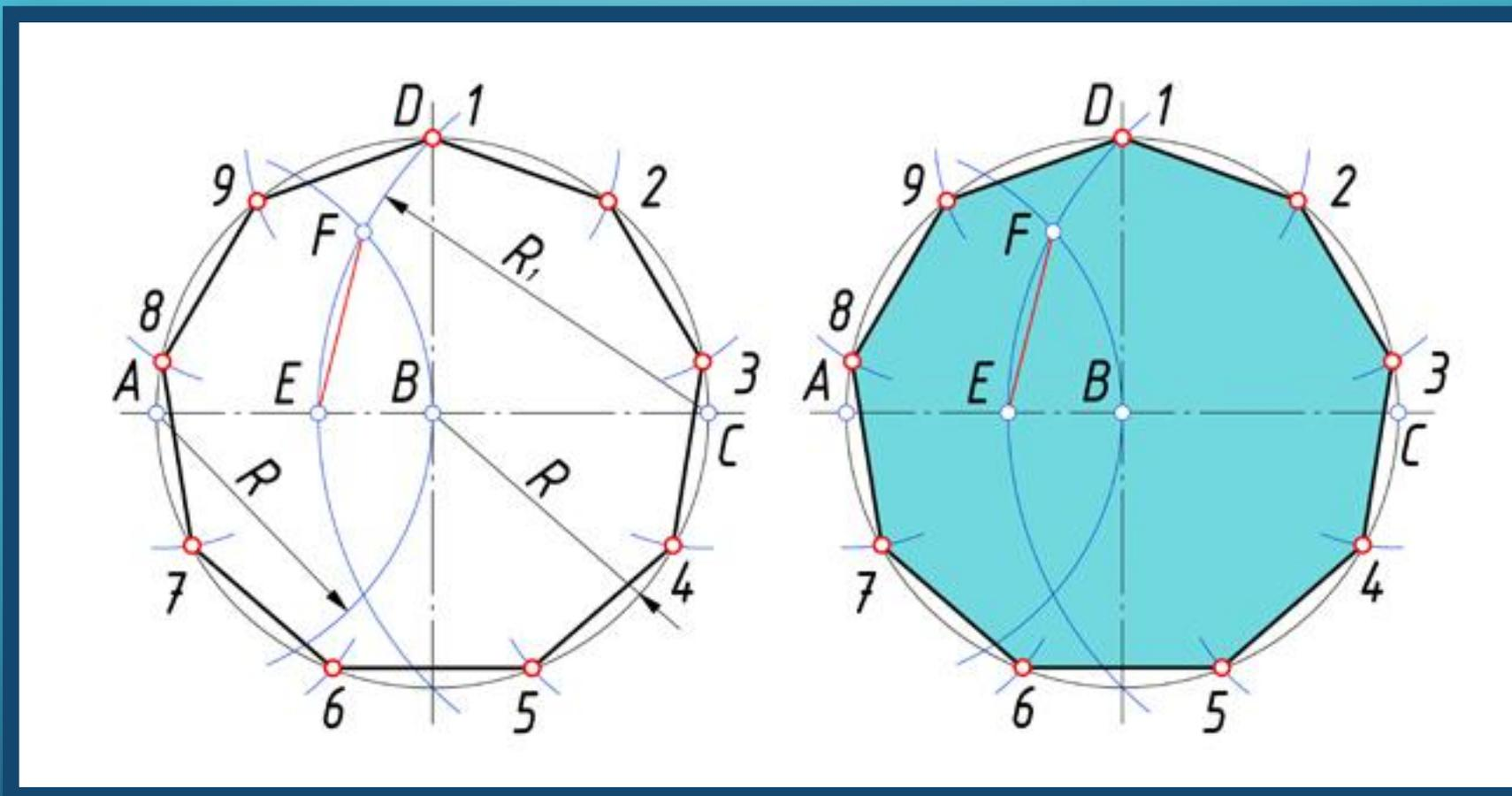
Деление окружности на 9 равных частей начинаем с проведения из точки  $A$  радиусом окружности  $R$  дуги. Из точки  $C$  построим вторую дугу радиусом равным отрезку  $CD$ , которая пересекает горизонтальную ось окружности в точке  $E$ . Соединив точку пересечения двух дуг  $F$  и точку  $E$ , получаем отрезок равный  $1/9$  длины окружности. Из точки  $1$  радиусом, равным отрезку  $FE$ , делают по окружности 9 засечек и получают девять искомых точек.
