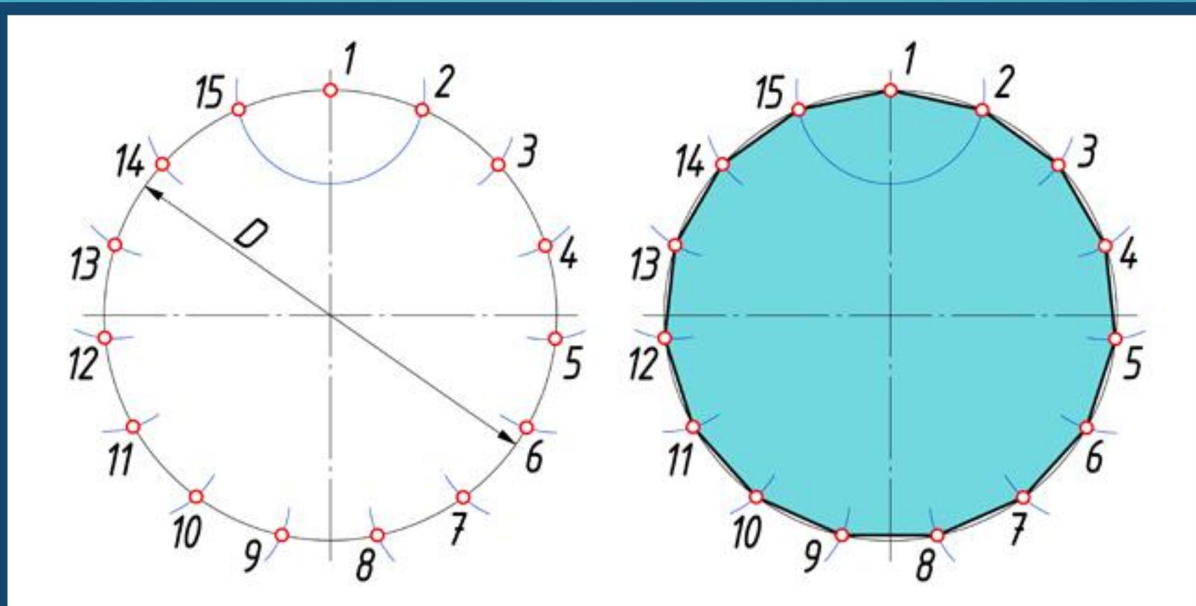
Зная, на какое число ( $n$ ) следует разделить окружность, находят по таблице коэффициент  $k$ . При умножении коэффициента  $k$  на диаметр окружности  $D$  получают длину хорды  $l$ , которую циркулем откладывают на окружности  $n$  раз
