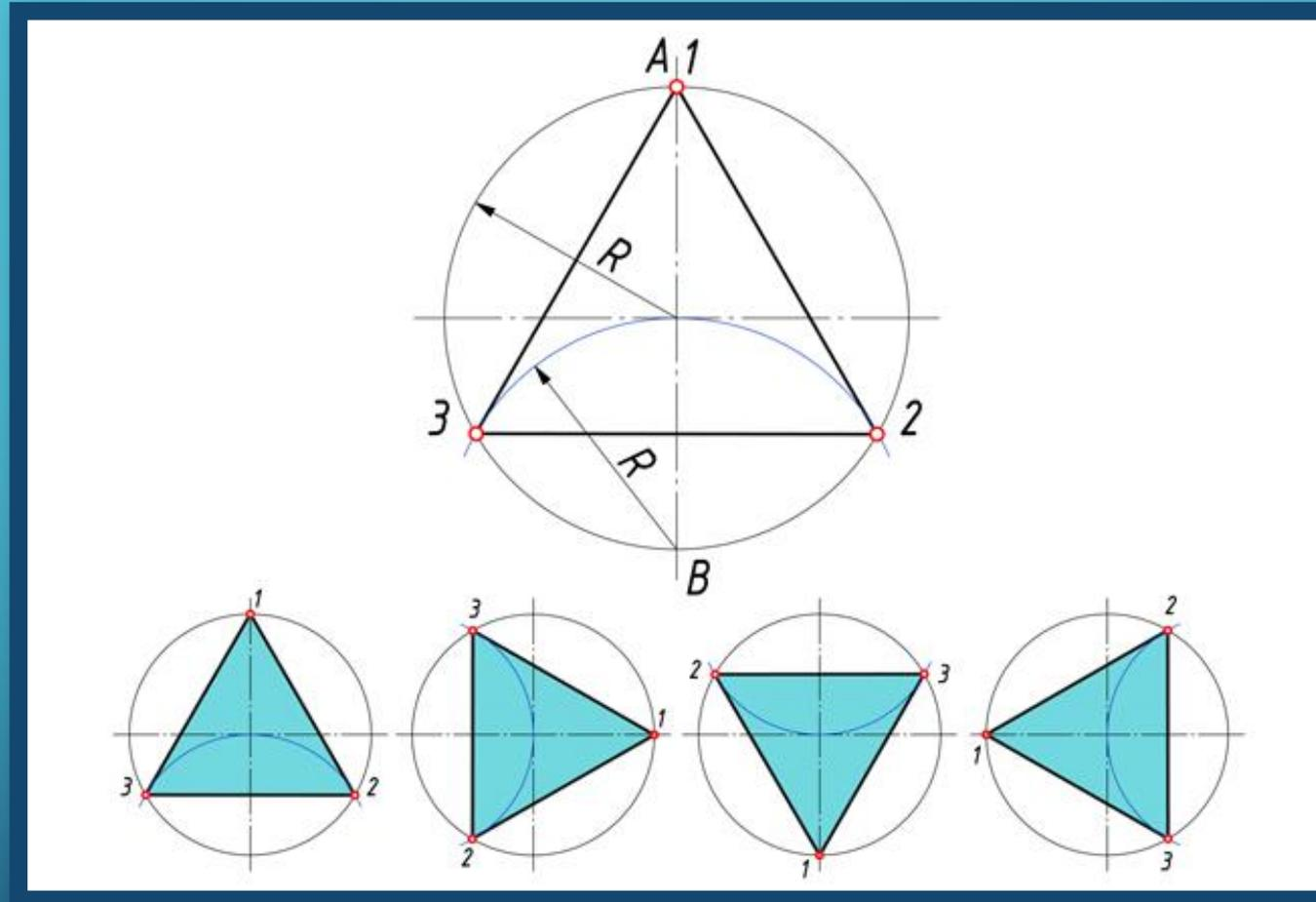
Для нахождения точек, делящих окружность радиуса  $R$  на 3 равные части, достаточно из любой точки окружности, например, точки  $B$ , провести дугу радиусом  $R$ . Пересечения дуги с окружностью дают две искомые точки 2 и 3; третья точка деления будет находиться на пересечении оси окружности, проведенной из точки  $A$ , с окружностью.
