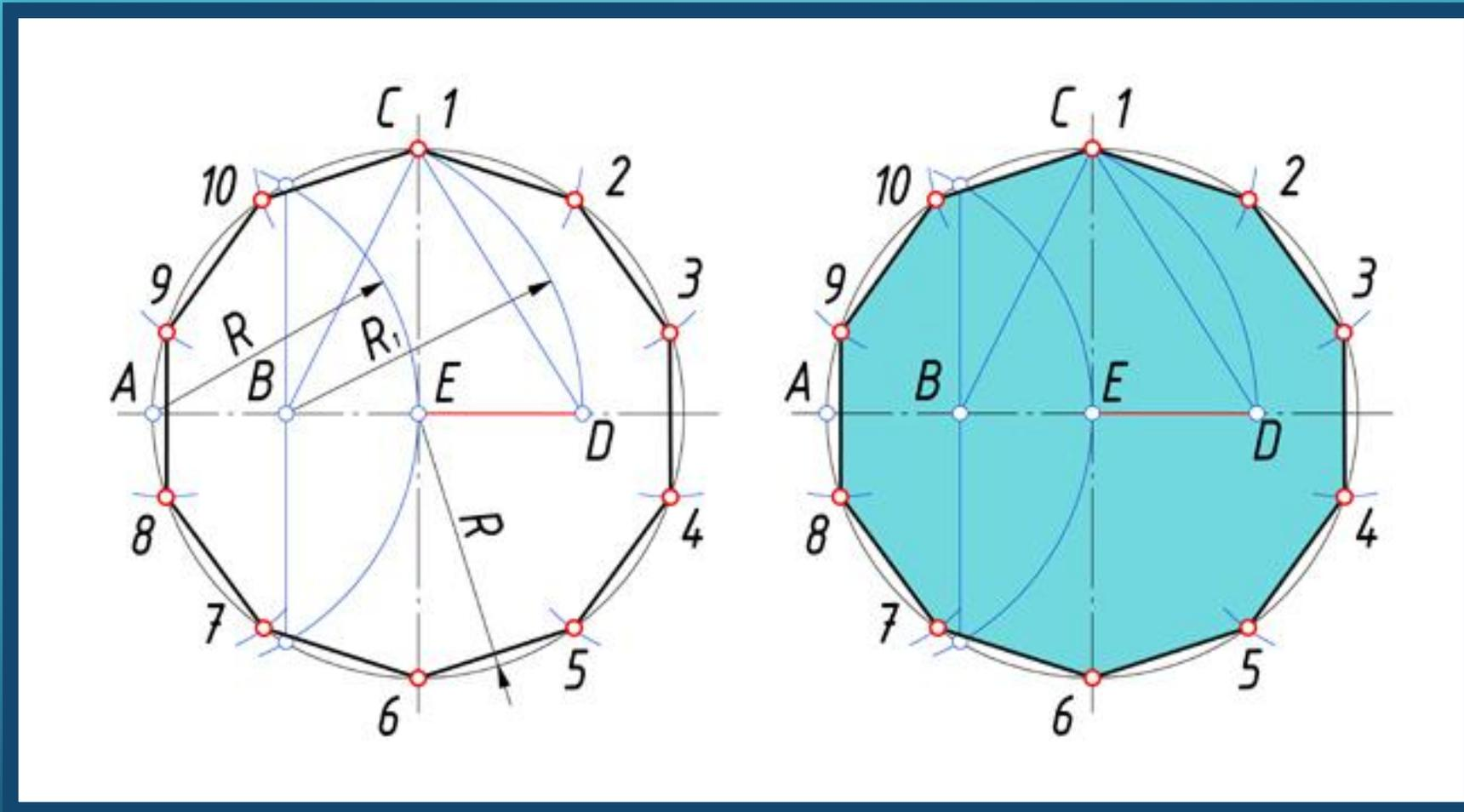
Чтобы разделить окружность на 10 равных частей, нужно сначала разделить ее на 5 равных частей. Отрезок  $ED$  является стороной десятиугольника. Из точки  $1$  радиусом, равным отрезку  $ED$ , делают по окружности 10 засечек и получают десять искомых точек.
