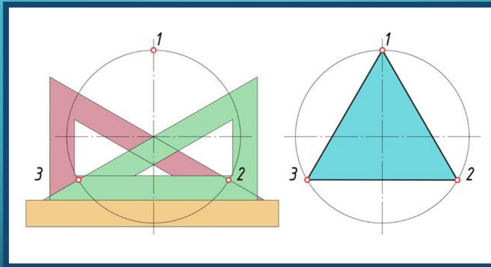
Разделить окружность на 3 части можно также угольником с углами  $30^\circ$  и  $60^\circ$ . Гипотенуза угольника должна проходить через центр окружности.
