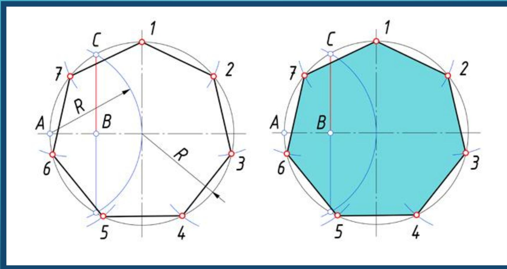
Из точки  $A$  проводим дугу радиусом окружности  $R$ , которая пересекает окружность в двух точках. Соединив точки пересечения прямой, при пересечении с горизонтальной осевой линией получаем точку  $B$ . Из точки  $C$  радиусом, равным отрезку  $CB$ , делаем по окружности 7 засечек и получают семь искомых точек.
