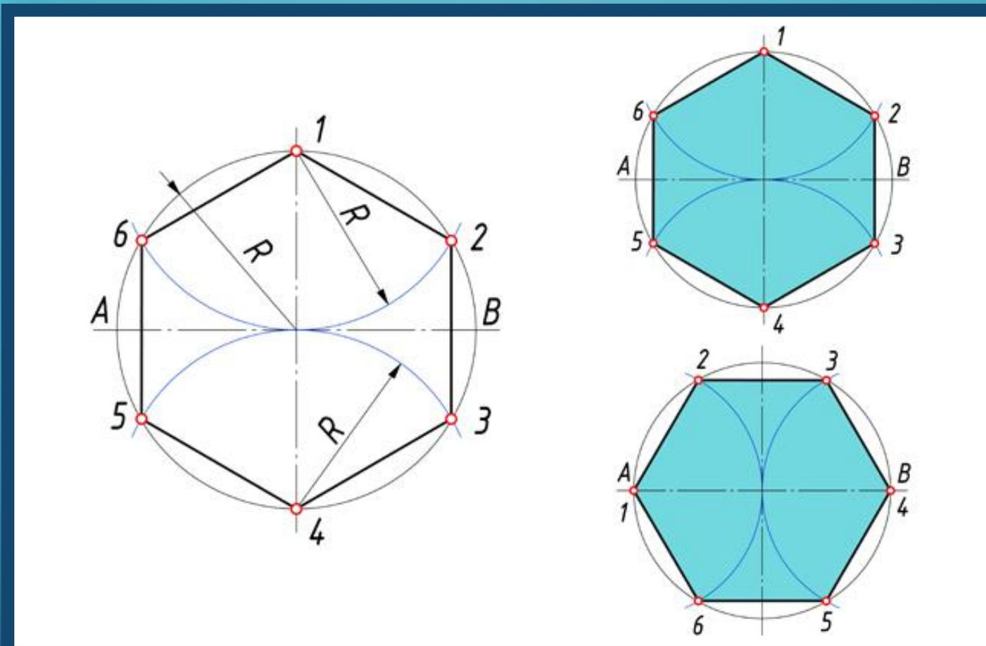
В этом случае выполняется то же построение, что и при делении окружности на 3 части, но дугу описывают не один, а два раза, из точек 1 и 4 радиусом окружности  $R$ .
