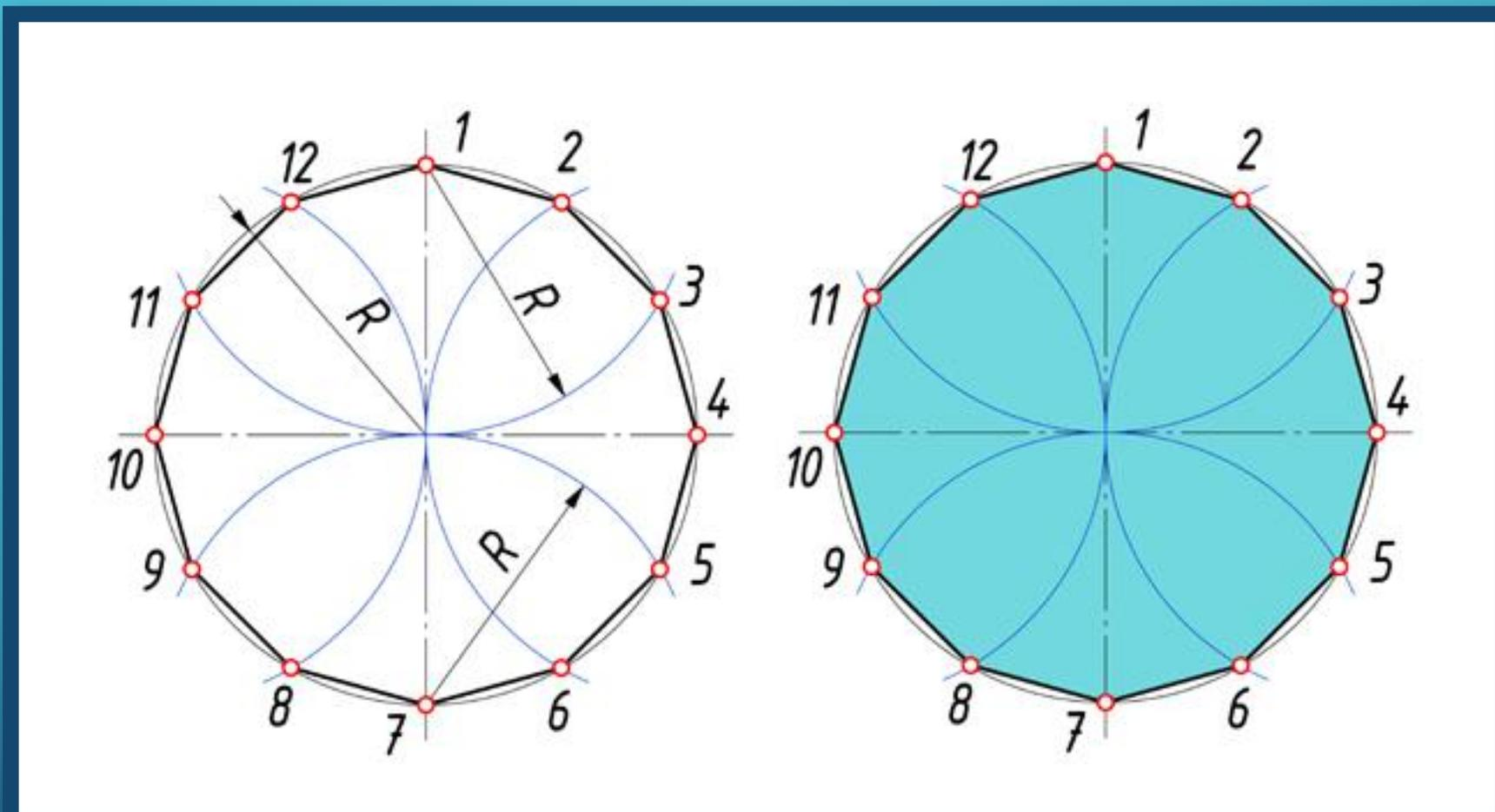
При делении окружности на 12 равных частей с помощью циркуля используют тот же прием, что и при делении окружности на 6 равных частей, но дуги радиусом окружности  $R$  описывать 4 раза из точек 1, 4, 7, 10.
