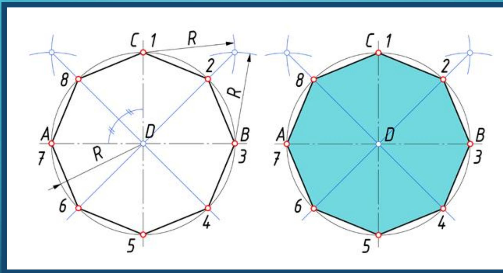
Чтобы разделить окружность на 8 равных частей, достаточно провести две пары диаметров, т.е. Объединить оба случая построения квадрата. Это построение два взаимно перпендикулярных диаметра окружности и прием деления прямого угла с помощью циркуля на две равные части.
