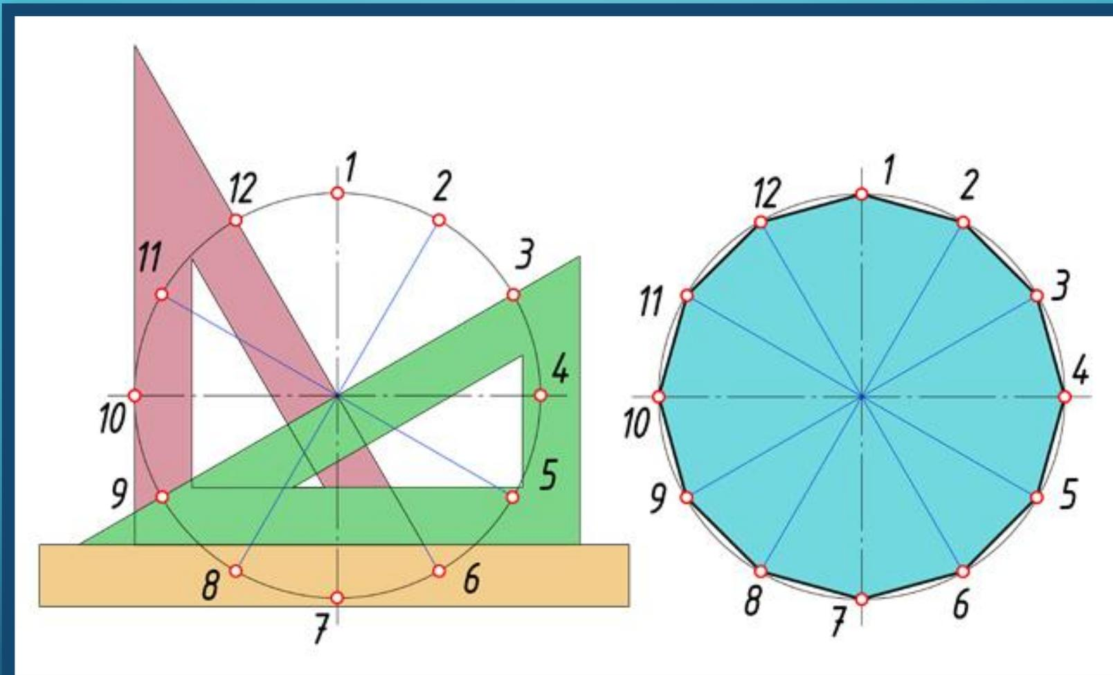
Используя угольник с углами  $30^\circ$  и  $60^\circ$  с последующим поворотом на  $180^\circ$ , делят окружность на 12 равных частей.
