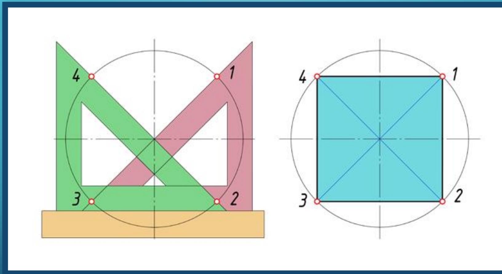
**Разделить окружность на 4 части можно с помощью угольника 45°. Гипотенуза угольника должна проходить через центр окружности.**
