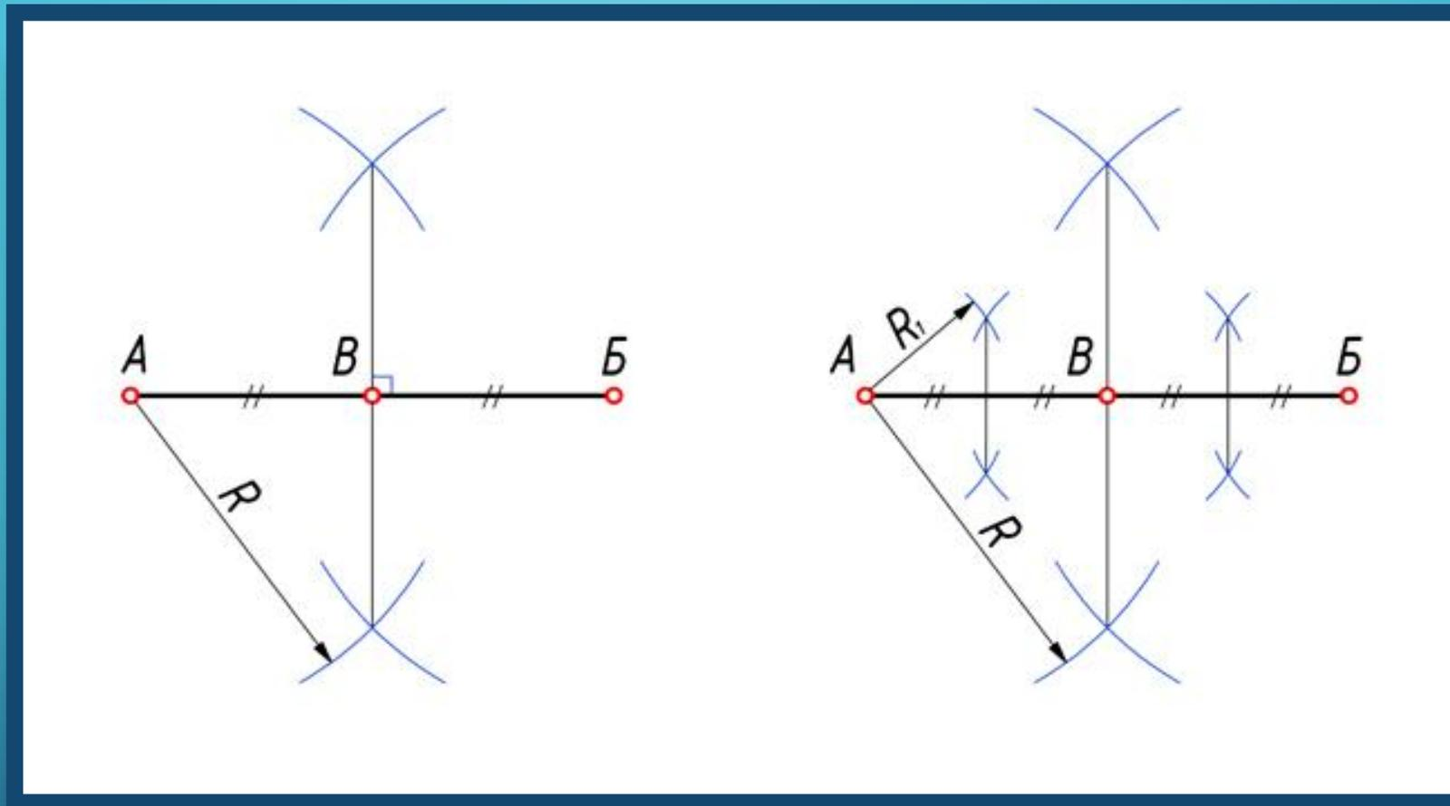
Чтобы разделить отрезок прямой пополам, из его концов проводим дуги радиусом больше половины длины этого отрезка. Точки пересечения дуг соединяем прямой линией, которая делит отрезок прямой на две равные части ( $AV=VB$ ) и является перпендикуляром к нему.
