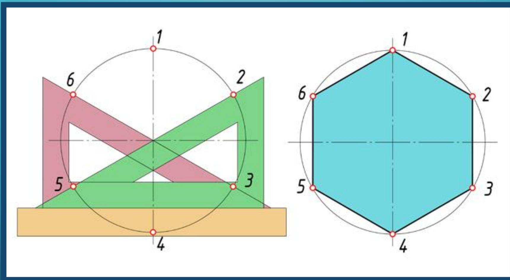
Разделить окружность на 6 равных частей можно и при помощи угольника с углами  $30^\circ$  и  $60^\circ$ . Гипотенуза угольника должна проходить через центр окружности.
