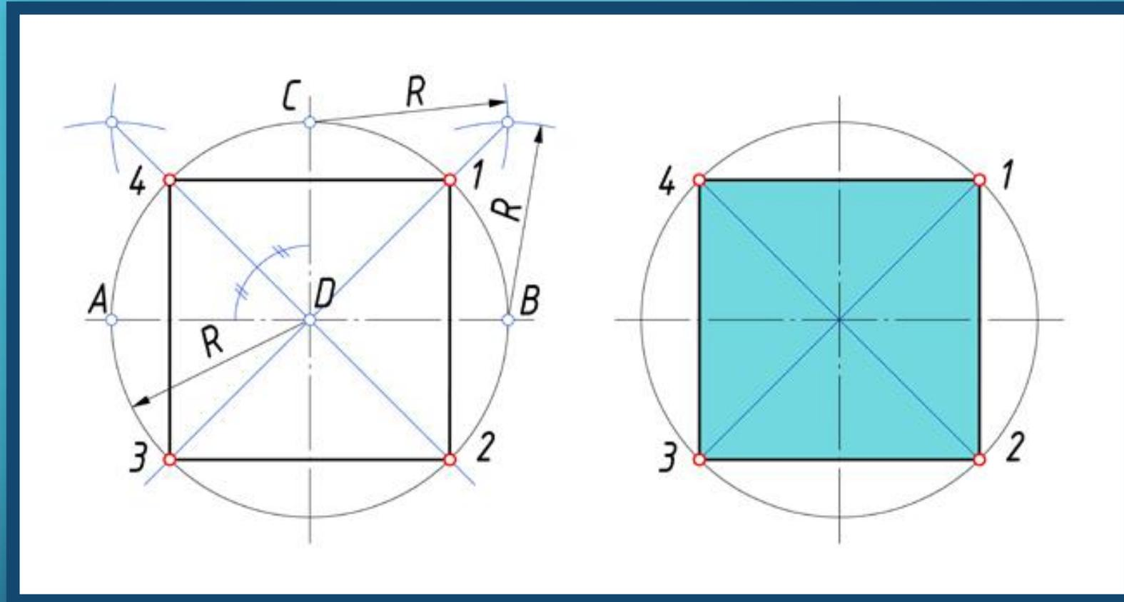
Чтобы разделить окружность на 4 части применяют прием деления прямого угла с помощью циркуля на две равные части. Из точек пересечения дуги окружности со сторонами угла (точки  $A$  и  $C$ ) проводим две пересекающиеся дуги радиуса равного радиусу окружности. Точку их пересечения соединяем с вершиной угла  $D$ . Угол  $ADC$  и дуга  $AC$  разделились пополам. Аналогично делим и угол  $CDB$ . Соединив последовательно все точки, получим квадрат.
